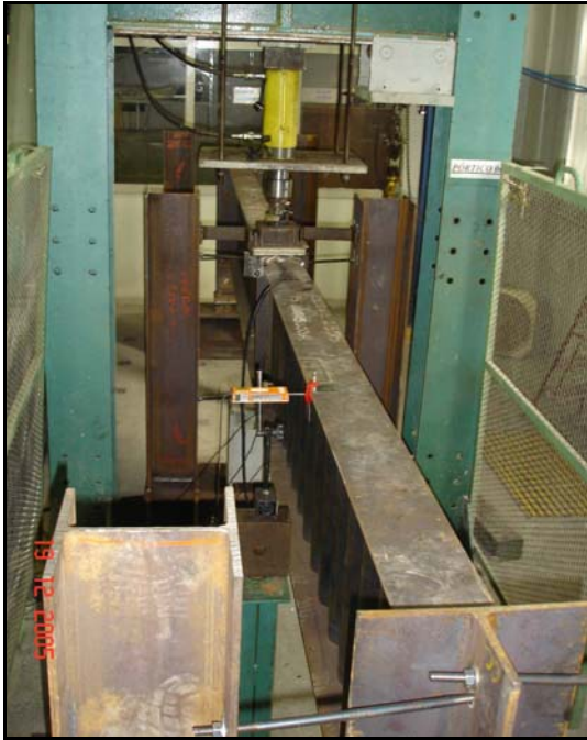
FIGURAS 4.19 – Transdutor de deslocamento linear (DT 50 ) colocado a \frac{1}{4} do vão do lado esquerdo da viga
