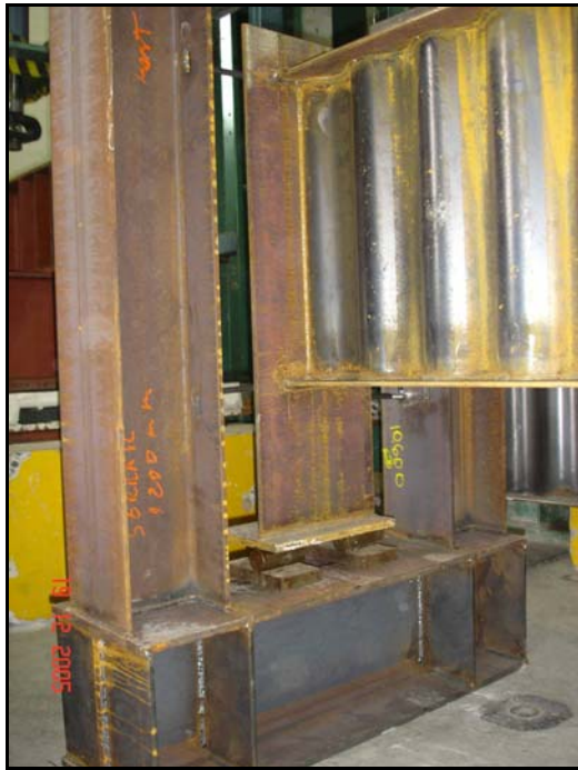
FIGURAS 4.12 – Roletes metálicos entre a viga e o apoio
