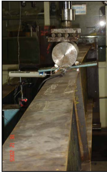
FIGURA 4.23 – PSS 600x150x8x2x5000 sem travamento central após o ensaio
