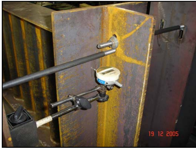
FIGURA 4.21 – Relógio comparador de leitura digital (REC) na extremidade da viga
