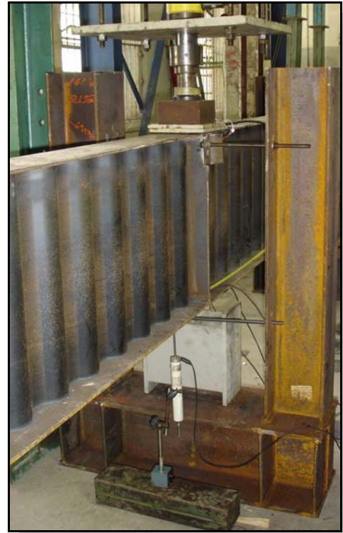
FIGURAS 4.10 – Esquema de montagem e instrumentação dos ensaios com travamento central
