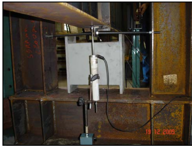
FIGURA 4.18 – Transdutor de deslocamento linear (DT 100 ) – seção central
