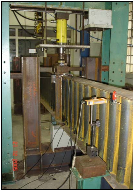
FIGURAS 4.10 – Esquema de montagem e instrumentação dos ensaios com travamento central
