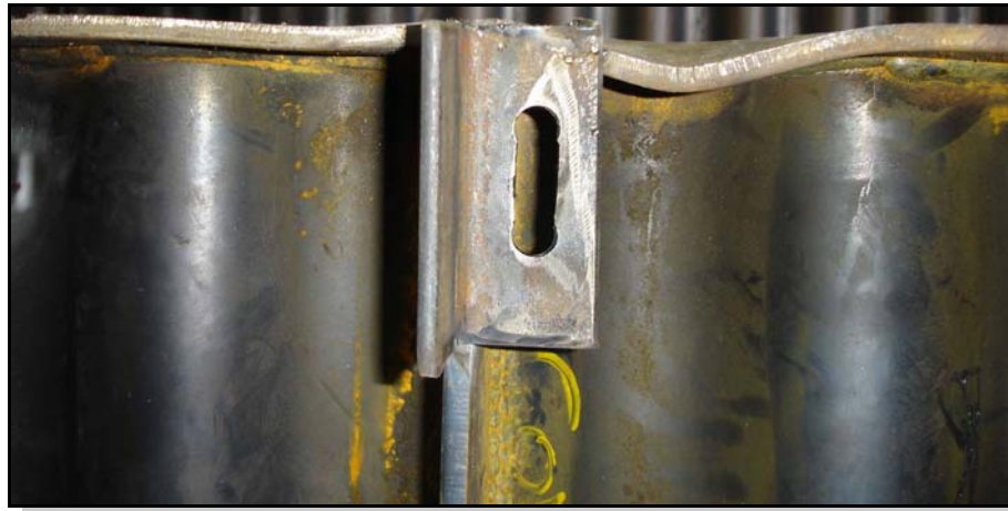
FIGURA 4.25 – PSS 600x150x8x2x5000 com travamento central após o ensaio
