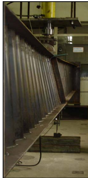
FIGURAS 4.24 – PSS 600x150x8x2x6000 sem travamento central após o ensaio
