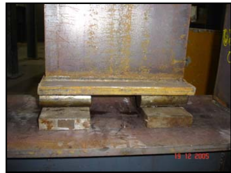
FIGURAS 4.12 – Roletes metálicos entre a viga e o apoio
