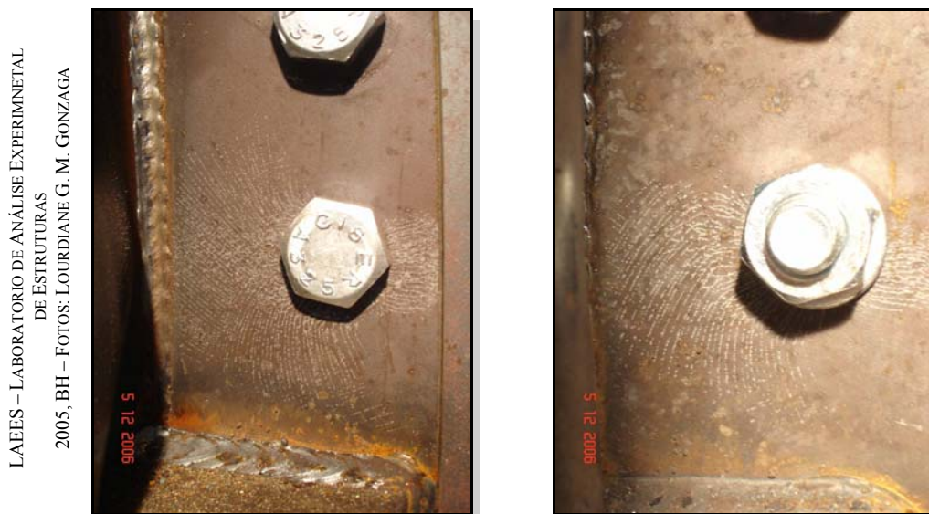
FIGURAS 4.43 – Protótipo 02 : Formação de linhas de LÜDER
