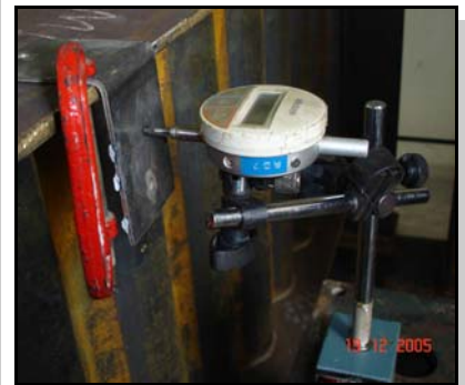
FIGURAS 4.20 – Relógio comparador de leitura digital (REC) colocado a \frac{1}{4} do vão do lado direito da viga
