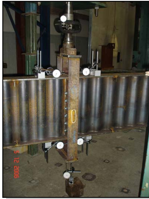
FIGURA 4.41 – Relógios comparadores nas mesas tracionada e comprimida
