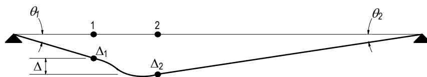
(f) Deformações de Vierendeel (com compatibilidade de rotações)
