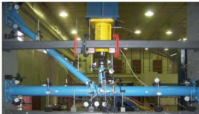
FIGURA 4.7 – Esquemático do carregamento e vista da instrumentação dos ensaios. [Vieira (2007)]
