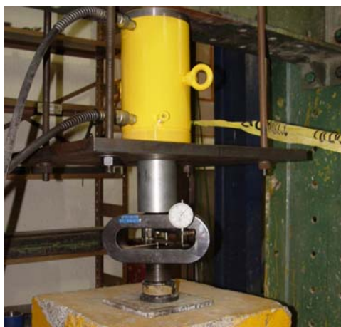
FIGURA 4.14 - Ensaio de calibração do transdutor de pressão
