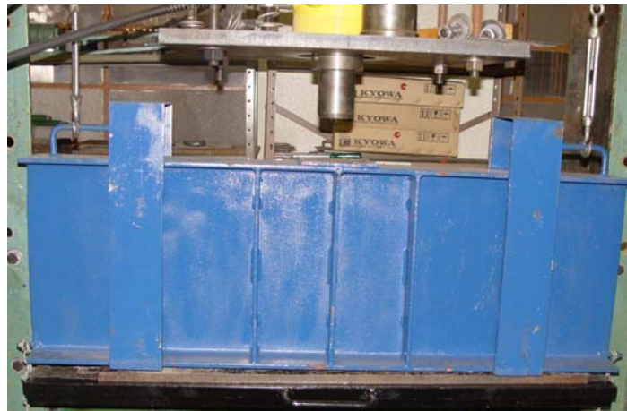
FIGURA 4.15 - Instalação da viga de distribuição e do apoio superior
