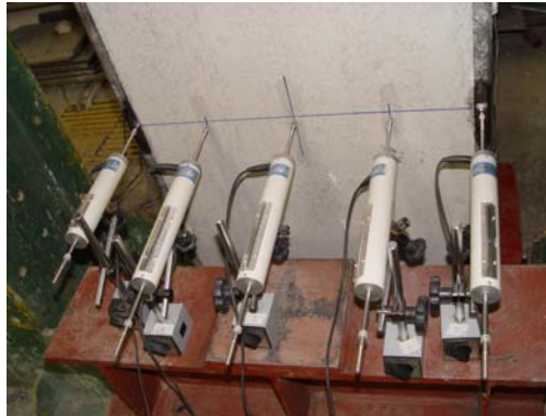
FIGURA 4.19 - Configuração 1 para captar os deslocamentos horizontais
