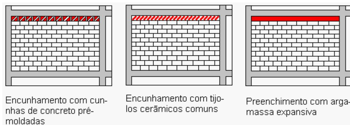
Figura 6.1 – Tipos de encunhamentos da alvenaria na estrutura
