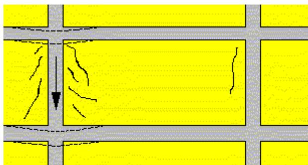
Figura 5.1 – Recalque diferencial de um pilar em relação a outros (THOMAZ, 1996)
