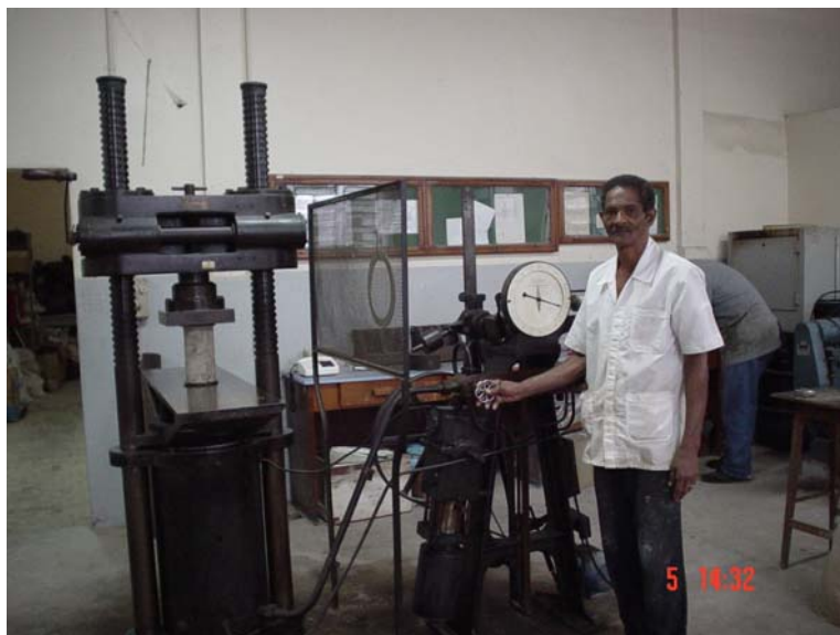
FOTO B.2: Prensa para o Ensaio de Resistência à Compressão.
