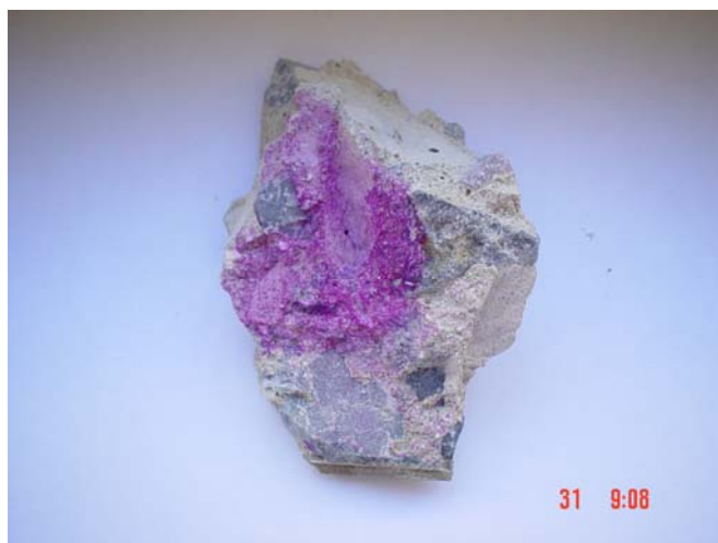
FOTO C.4: Amostra de concreto feito com cimento CP III 32 RS, agregado calcário dolomítico e submetido à solução S50 por 180 dias.
