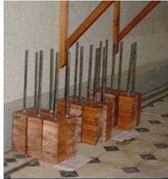
FIGURA 3. 2– Condicionamento dos CPs para o ensaio de arrancamento
