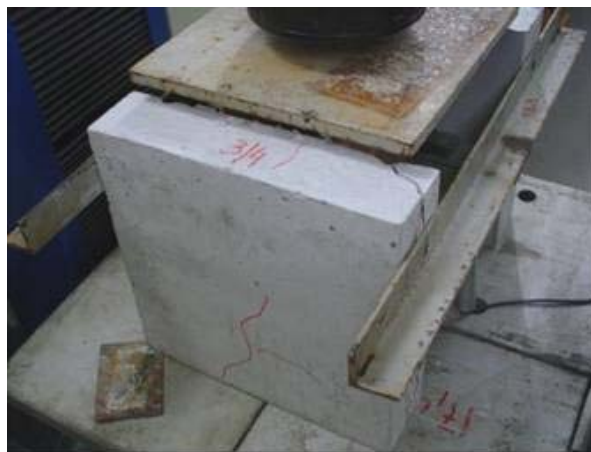
FIGURA 4. 30– Fissuração do concreto nos CPs tipo A – conectores de 8 mm
