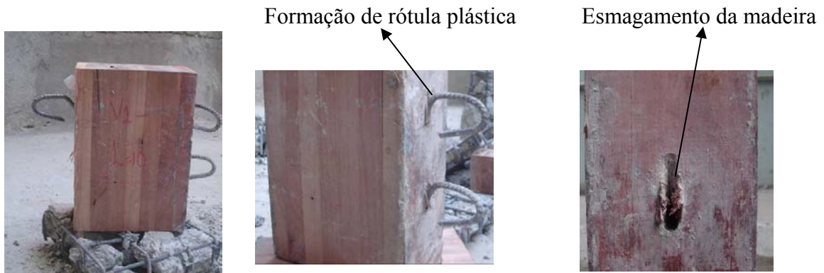
FIGURA 4. 29– Modo de ruptura para os CPs tipos A e B – conectores de 8 mm
