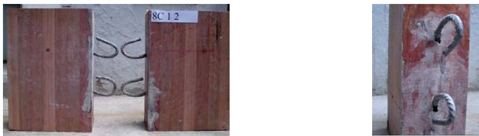
FIGURA 4. 31 – Modo de ruptura dos CPs tipo C – conectores de 8 mm
