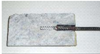
FIGURA 4. 23 - CP de concreto serrado, após a ruptura
