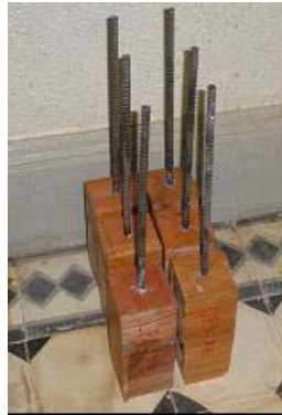
FIGURA 3. 5 – Detalhe dos corpos-de-prova para o ensaio de arrancamento
