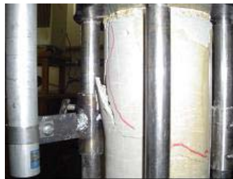
FIGURA 4. 24 - Arrancamento de barra de aço, com gancho, em CP de concreto
