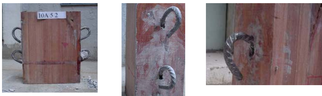
FIGURA 4. 33– Modo de ruptura dos CPs tipo A – conectores de 10 mm e 12,5 mm
