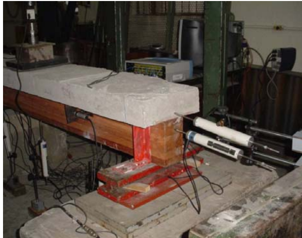
FIGURA 3. 32 – Detalhe da medição do deslizamento relativo de extremidade
