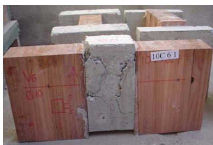
FIGURA 4. 38– Fissuração do concreto nos CPs tipo C – conectores de 10,0 mm
