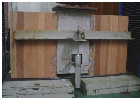
FIGURA 4. 32– Fissuração do concreto nos CPs tipo C – conectores de 8,0 mm
