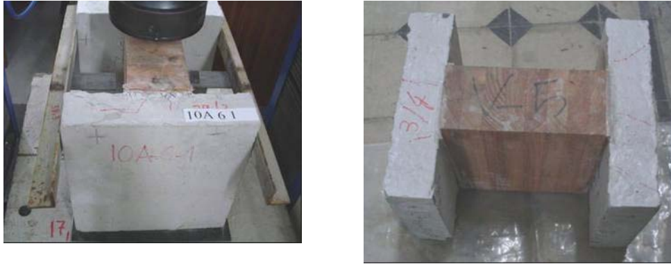
FIGURA 4. 34 – Fissuração do concreto nos CPs tipo A – conectores de 10 mm
