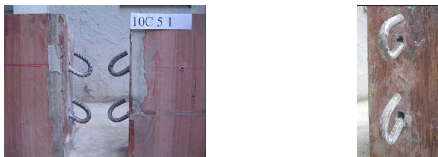
FIGURA 4. 37– Modo de ruptura dos CPs tipo C – conectores de 10 mm
