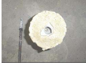
FIGURA 4. 22 - Arrancamento de barras de aço em CPs de concreto
