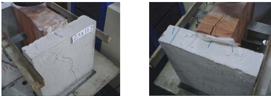
FIGURA 4. 35– Fissuração do concreto nos CPs tipo A – conectores de 12,5 mm
