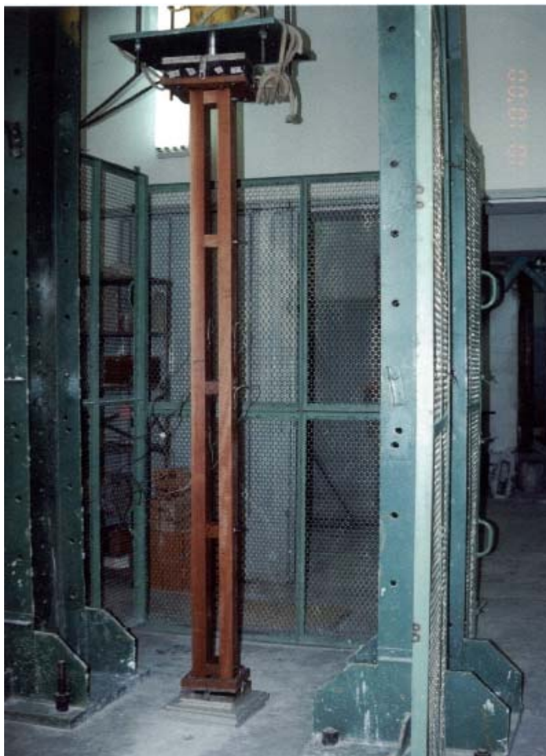
Figura 9 – Pilar Composto Posicionado para ensaio
