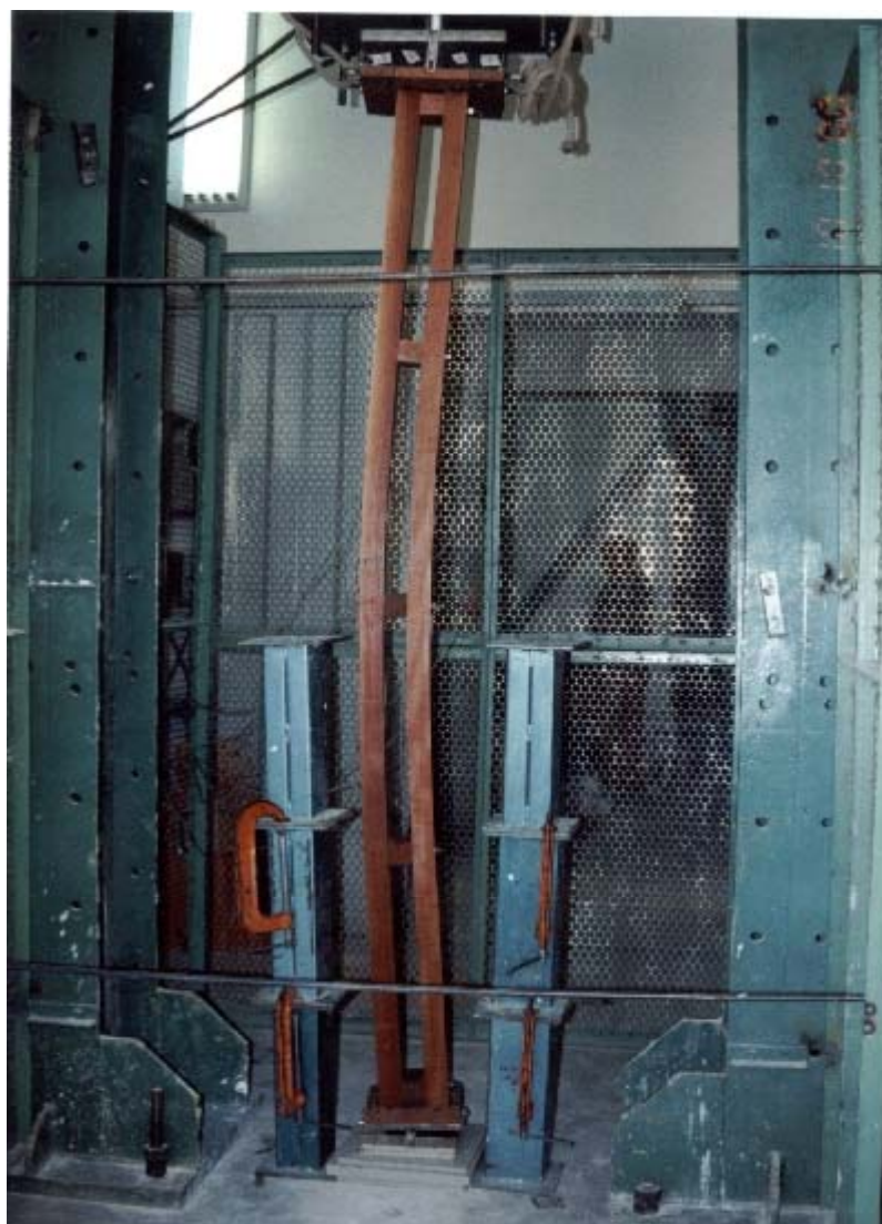
Figura 13 – Flambagem do Pilar Composto 04
