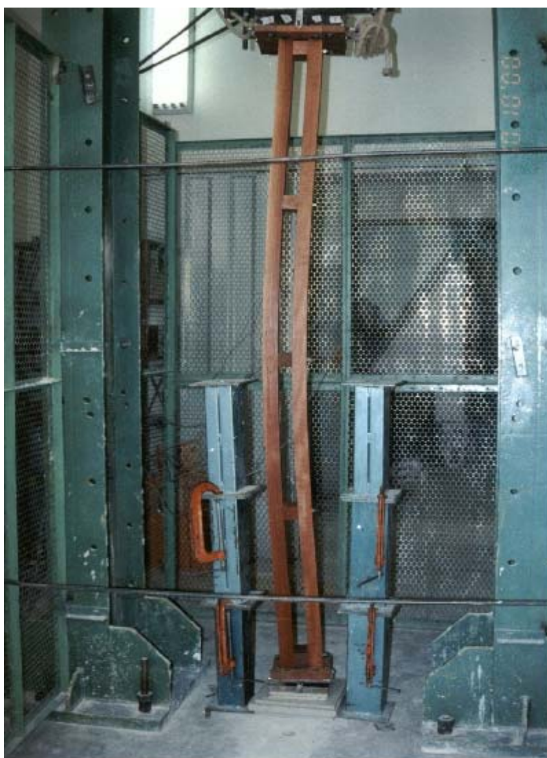
Figura 12 – Flambagem do Pilar Composto 02
