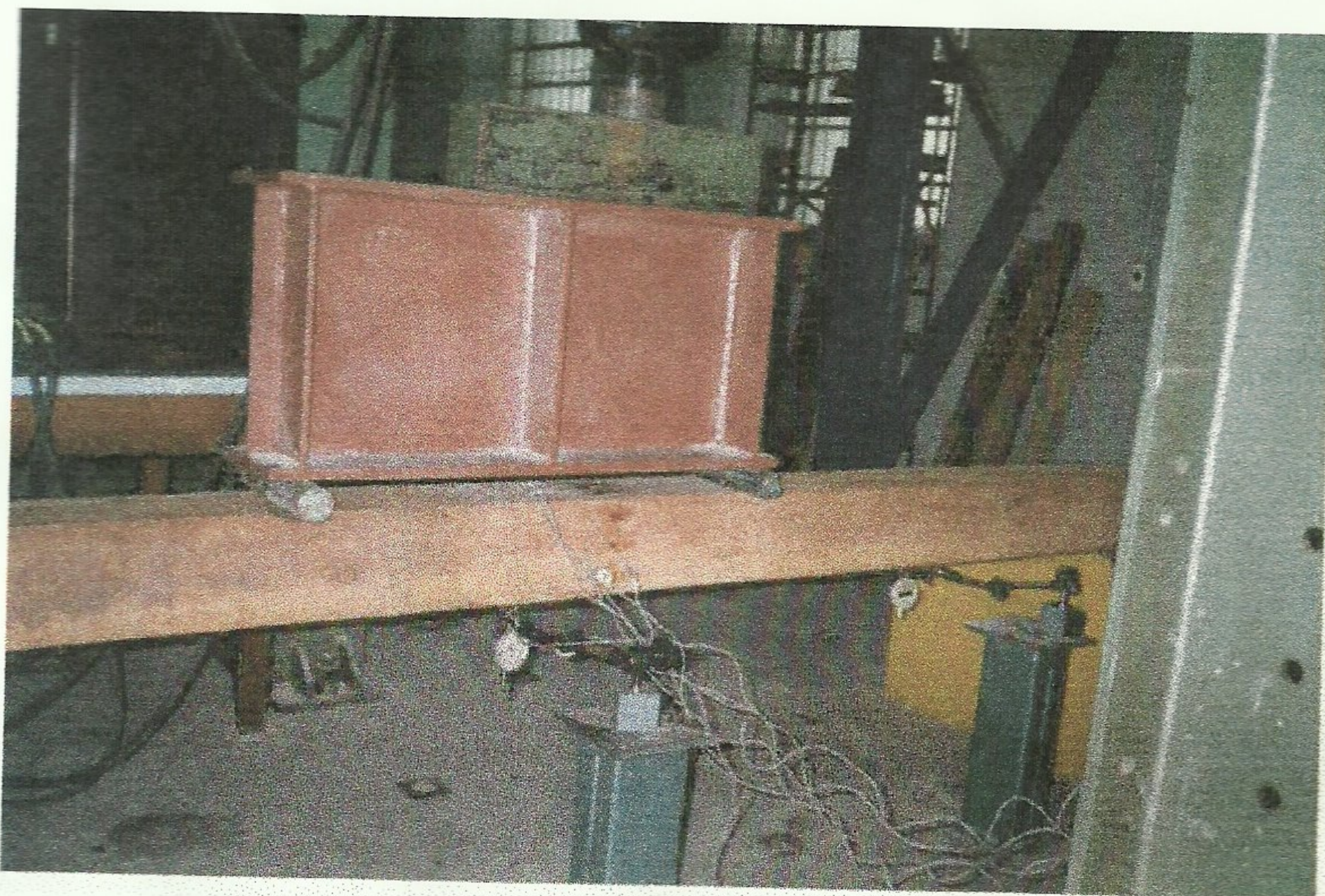
FOTO 1-Ensaio da Viga de Madeira
