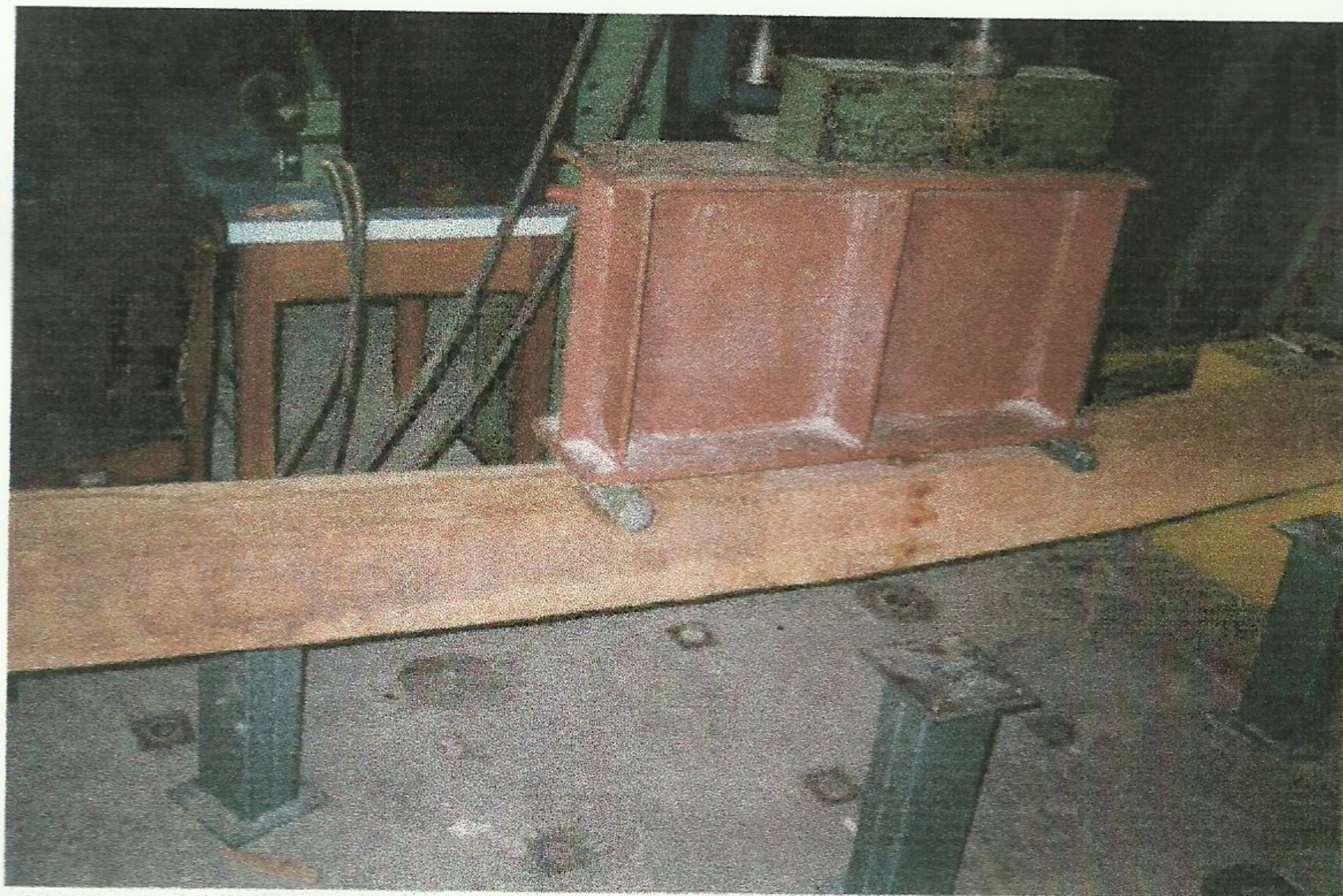
FOTO 4- Flecha da Viga de Madeira
