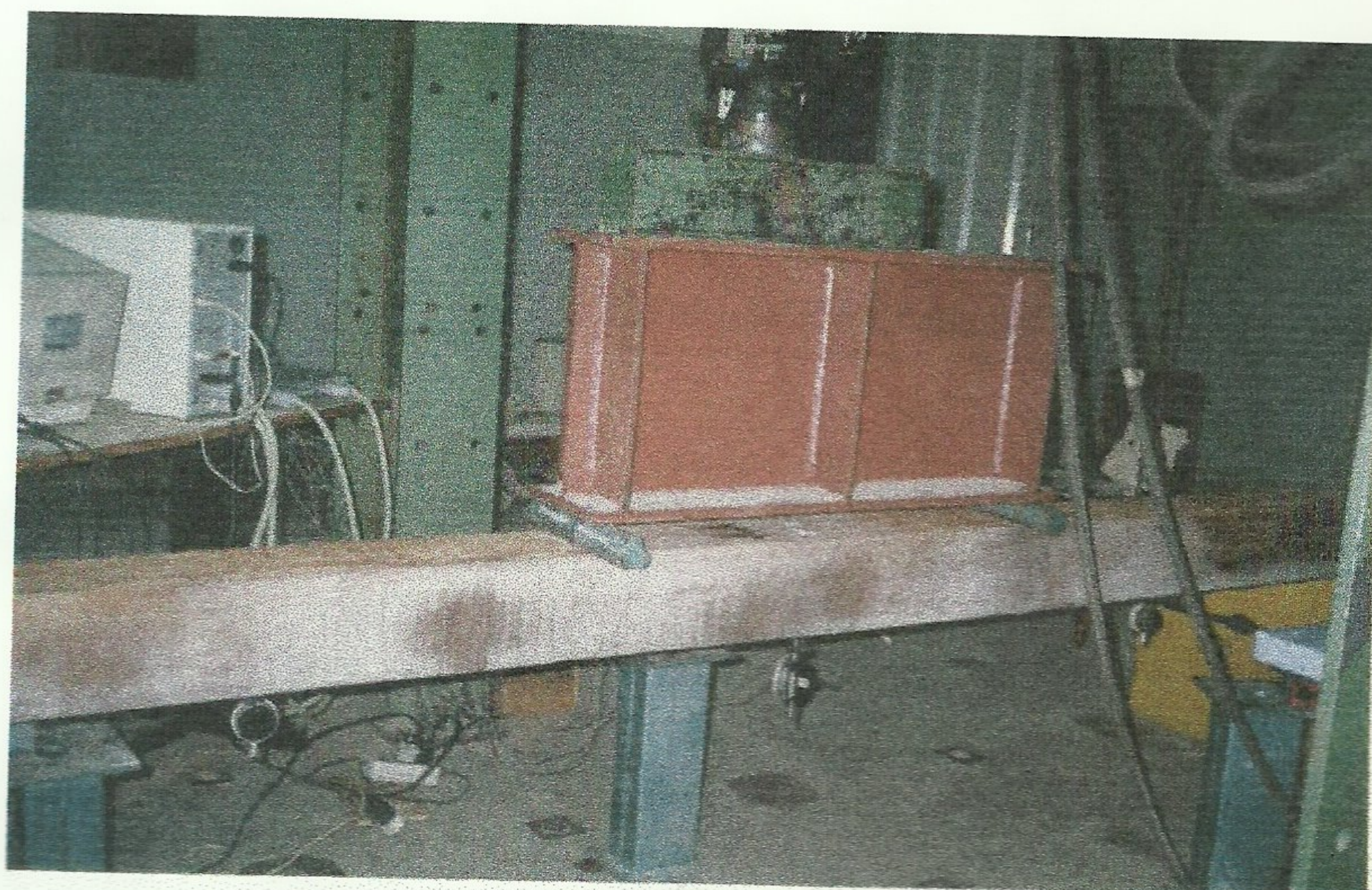
FOTO 2- Detalhe da Aplicação de Carga da Viga
