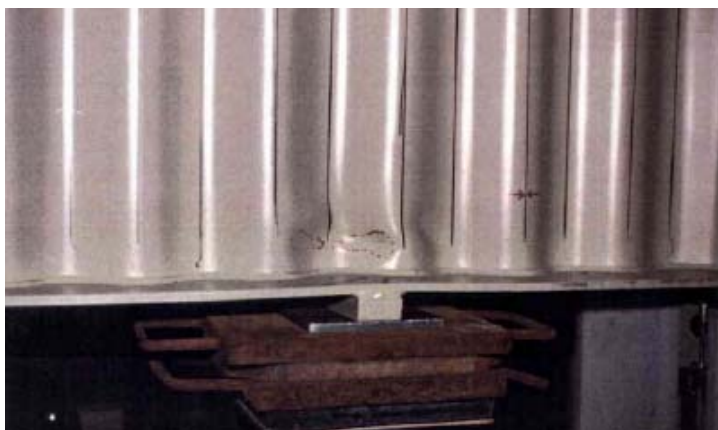
FIGURA 3.21 – Mecanismo de colapso do ensaio em Viena (sem enrijecedores) [PIMENTA (2007)]
