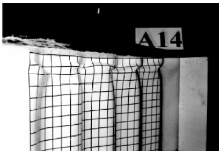
FIGURA 3.16 – Fase final do ensaio mostrando o enrugamento da alma [MACHACEK e TUMA (2006)]
