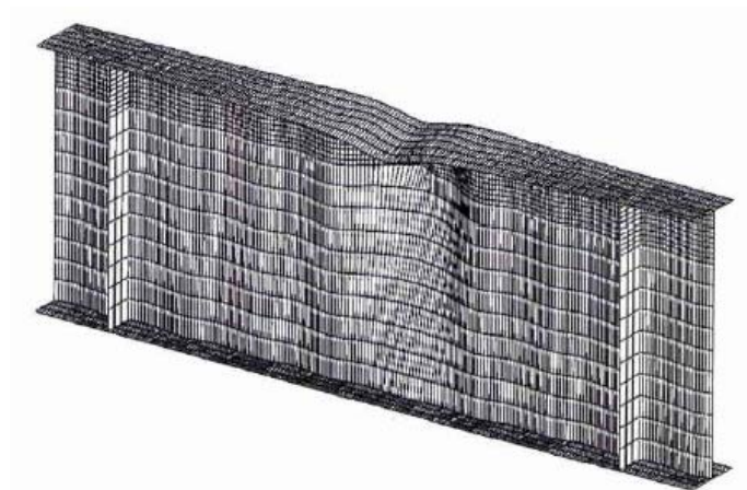
FIGURA 3.29 – Modo de falha por flambagem global da alma [PASTERNAK e BRANKA (1999)]
