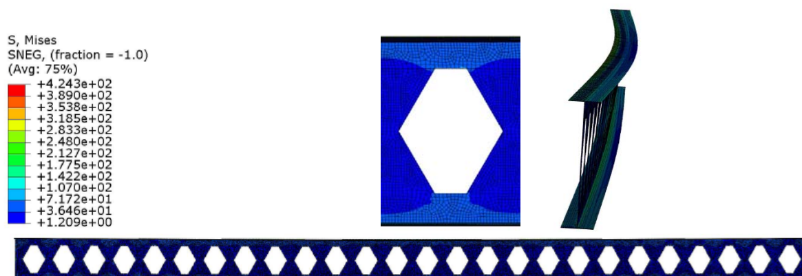
Figura 4.17 - Distribuição de tensões de von Mises da viga VCA 925,5x230x22,2x13,1 com 17,48 m de vão
