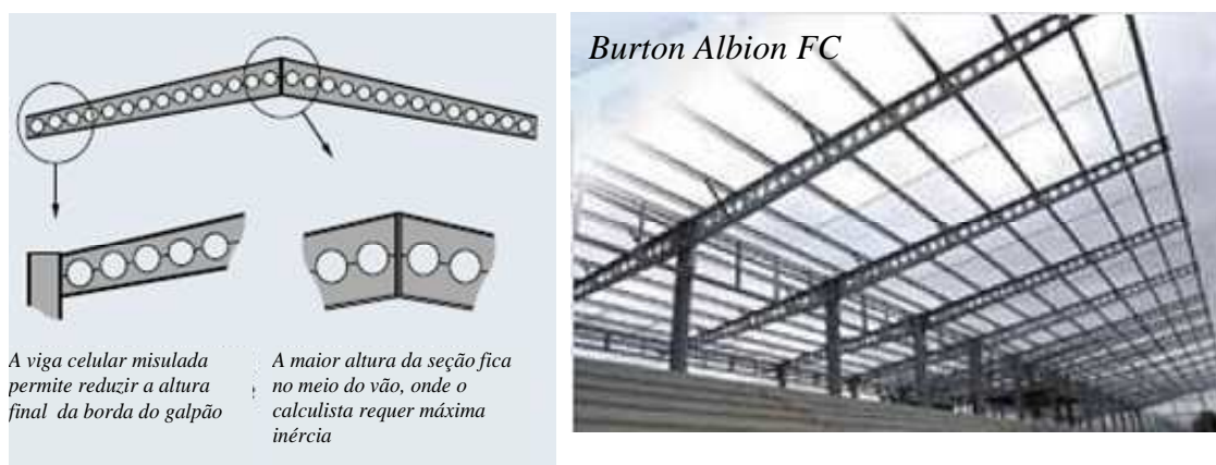
FIGURA 1.11 - Aplicações práticas de vigas celulares misuladas (fonte: www.asdwestok.co.uk , acessado em 10/2010)
