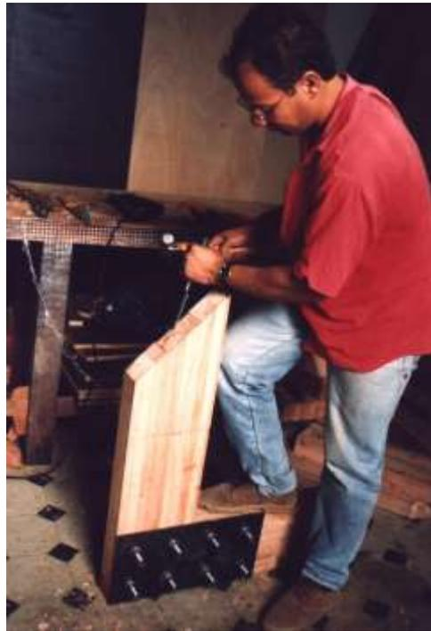
Figura 5.9 – Corpo de prova sendo preparado para receber uma parte da rótula
