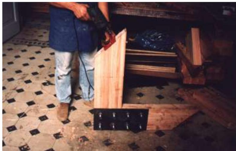
Figura 5.10 – Parte da rótula sendo parafusada nas extremidades do corpo de prova
