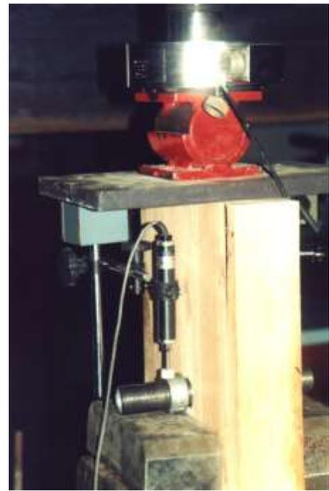
Figura 5.16 – Detalhes dos corpos de prova de embutimento e do posicionamento dos DT's
