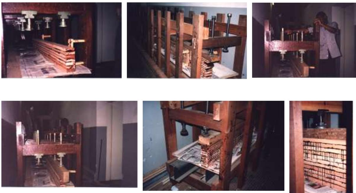
Figura 5.6 – Sequência da colocação do conjunto sob a prensa
