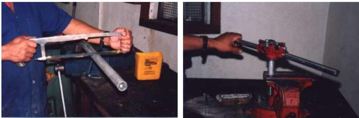
Figura 5.7 – Corte e roscas nas extremidades dos tubos
