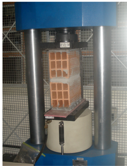
FIGURA 3.5 Esquema de ensaio para determinação da resistência à compressão dos prismas – ressaltando a posição dos furos.
