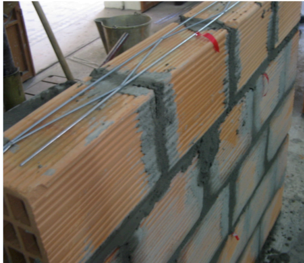
FIGURA 3.8 Identificação das mini-paredes com armadura para o ensaio de compressão uniaxial.
