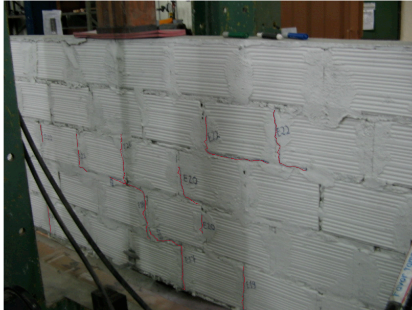
FIGURA 3.33 Modo de ruptura da mini-parede 1 da Série 1.
