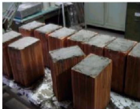
FIGURA 3.3 Esquema de ensaio para determinação da resistência à compressão dos blocos cerâmicos – ressaltando a posição dos furos.
