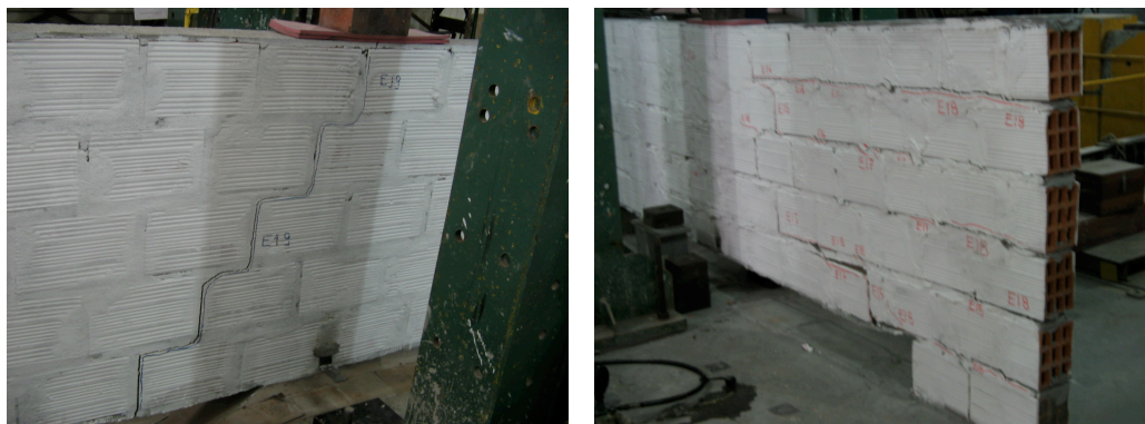
FIGURA 3.37 Modo de ruptura da mini-parede 1 e 2 da Série 3.
