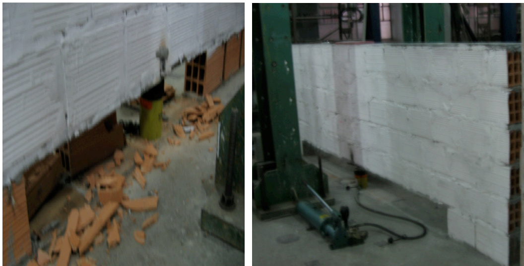
FIGURA 3.19 Retirada dos blocos centrais e instalação de um macaco hidráulico.
