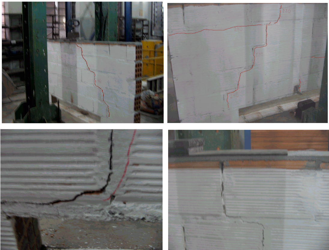
FIGURA 3.27 Modo de ruptura e detalhe da espessura das fissuras da mini-parede 2 da Série 1 .
