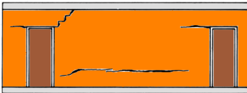
FIGURA 1.1 Fissuras em alvenaria de vedação com presença de aberturas devidas à excessiva deformabilidade de vigas e lajes (adaptada de Pfeffermann, 1975).
