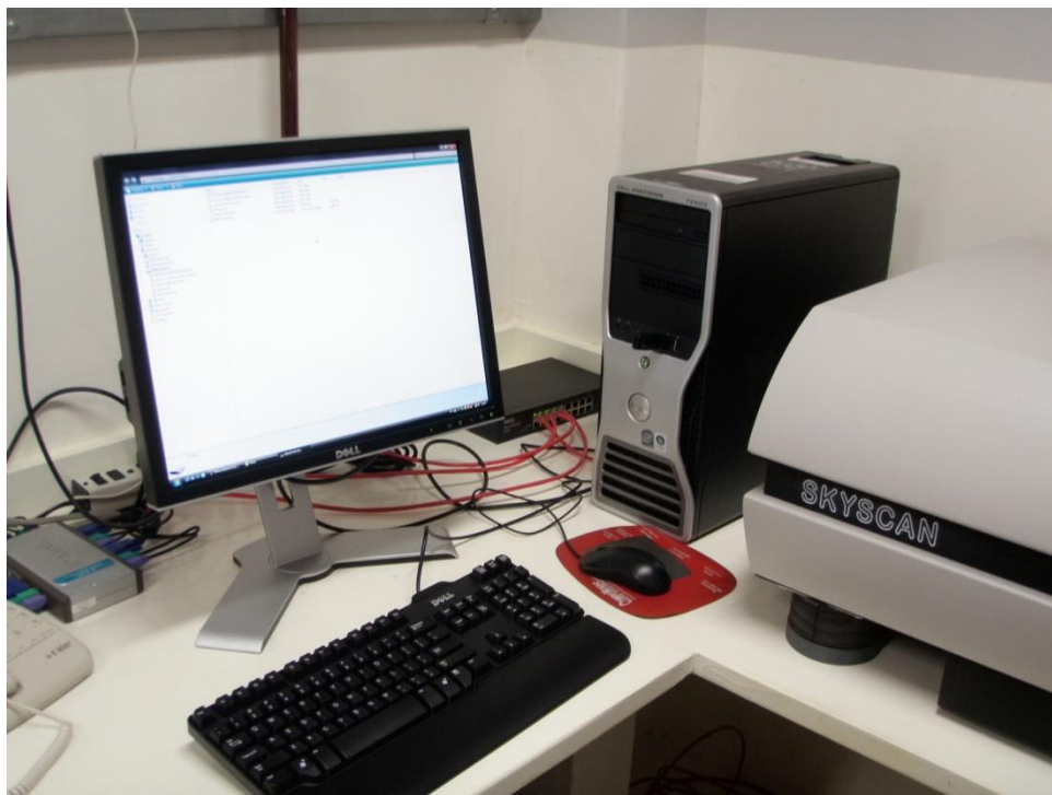
Figura 30 Computador que controla o microtomógrafo de raios X SkyScan 1172
