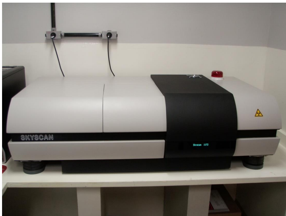
Figura 29 Microtomógrafo de raios X SkyScan 1172
