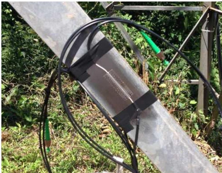
Figura 4.35 – Sensor de deformação soldado à estrutura da torre.
