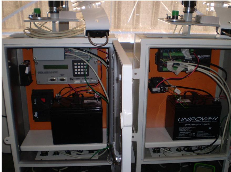
Figura 4.12 – Caixa de proteção e fixação dos componentes do sistema de aquisição de dados.
