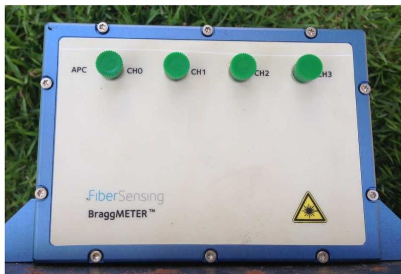
Figura 4.22 – “Datalogger” óptico FS2200.
