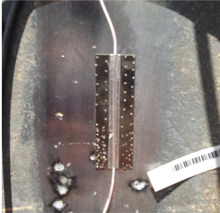
Figura 4.37 – Sensor de deformações danificado devido a dificuldades de soldagem.
