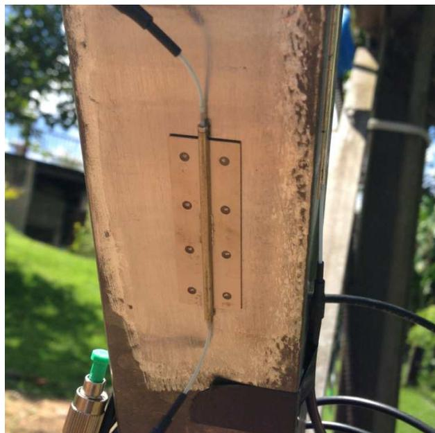
Figura 4.36 – Sensor de temperatura soldado à estrutura da torre.
