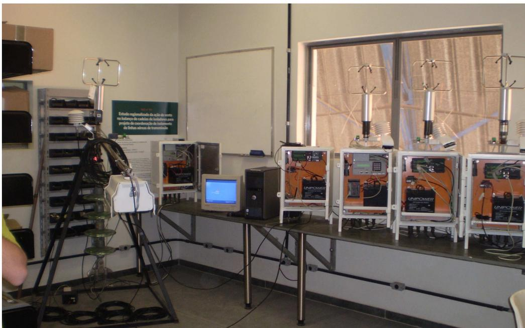
Figura 4.14 – Montagem finalizada em laboratório das quatro estações meteorológicas e do sistema de medição de ângulo com a câmera de registro digital.
