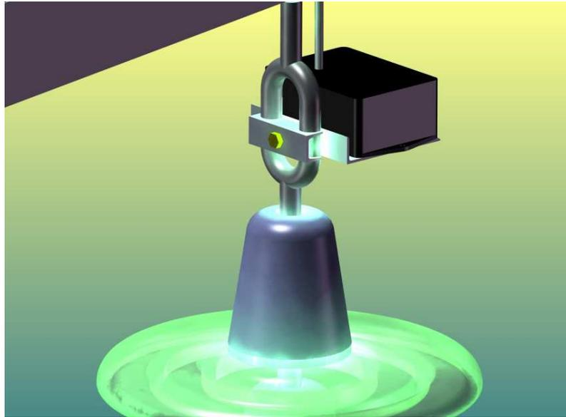
Figura 4.13 – Fixação da plataforma inercial na cadeia de isoladores.
