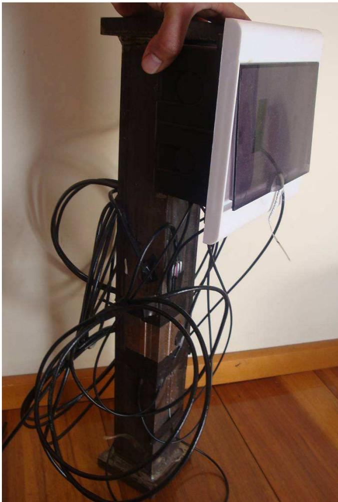
Figura 4.20 – Protótipo em cantoneira para validação dos sensores ópticos.
