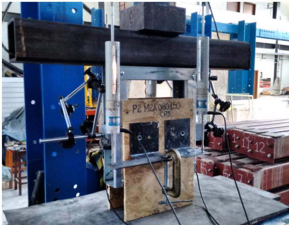
Figura 3.101: Modelo M2A 200 600 150 CP2 - Modelo ajustado para ensaio.
