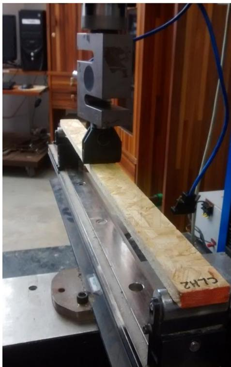
Figura 3.16: Corpo de prova da Série CL posicionado para ensaio, V=48xt.
