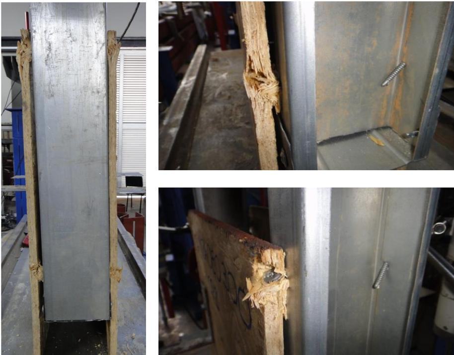
Figura 3.87: Modelo M2A 090 400 300 CP2 - À esquerda, modo de falha “*pull-over*” lado P2E e à direita, PID.
