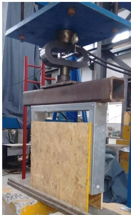
Figura 3.41: Demonstração da montagem e do sistema de aplicação e controle de força.
