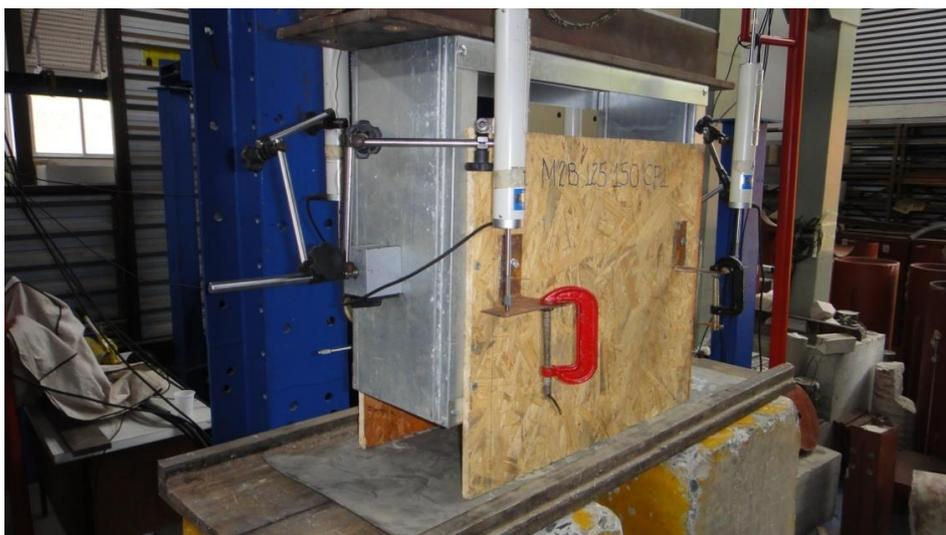
Figura 3.62: Modelo M2B 200 600 150 CP1 - Perfil utilizado possui a alma com largura maior que o perfil utilizado nos modelos da Série 3.
