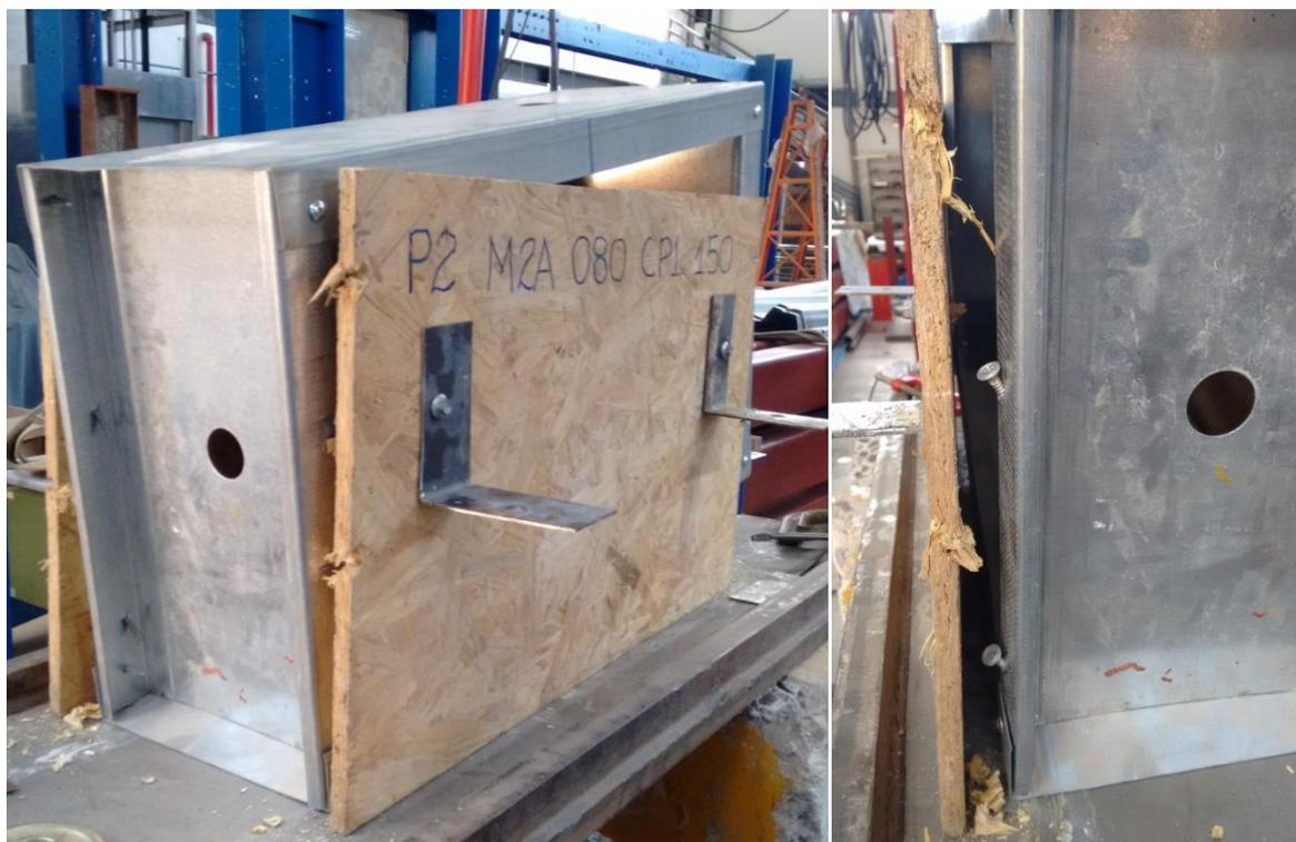
Figura 3.100: Modelo M2A 200 600 150 CP1 - Ruptura do modelo no seu lado direito apresentando o modo de falha "pull-over".
