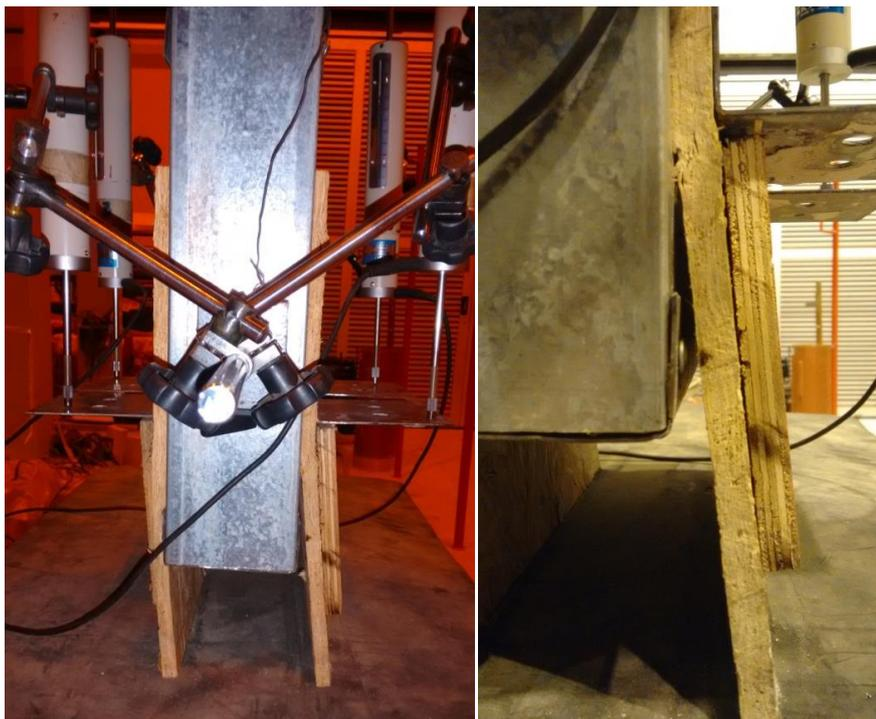
Figura 3.109: Modelo M2A 200 600 150 CP3 - Empenamento nas placas de OSB, interrupção do ensaio.
