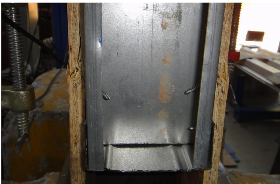
Figura 3.49: Modelo M2B 090 600 150 CP3 - Ruptura pontual da placa de OSB na região dos parafusos, lado direito do modelo (P1D e P2D).
