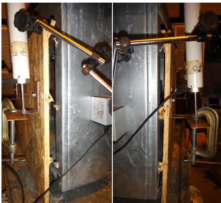
Figura 3.77: Modelo M2B 200 600 150 CP3 - Desprendimento total da placa de OSB no lado esquerdo do modelo (à esquerda, P2E e à direita P1E).
