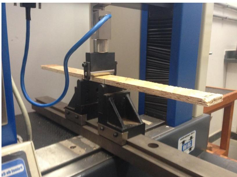
Figura 3.5: Corpo de prova posicionado para ensaio da Série AL, V=8xt.
