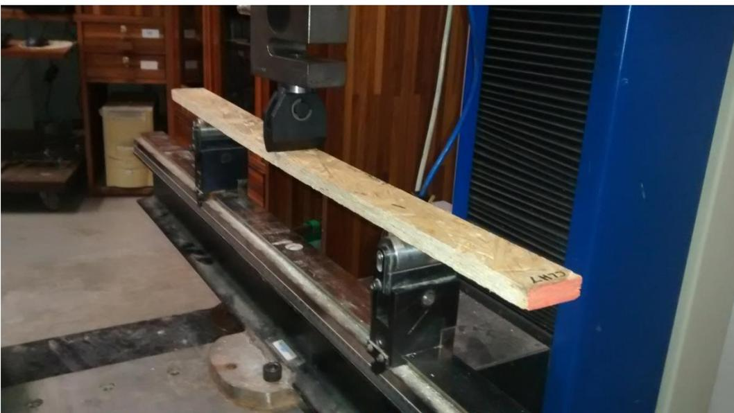
Figura 3.15: Corpo de prova da Série CL posicionado para ensaio, V=32xt.
