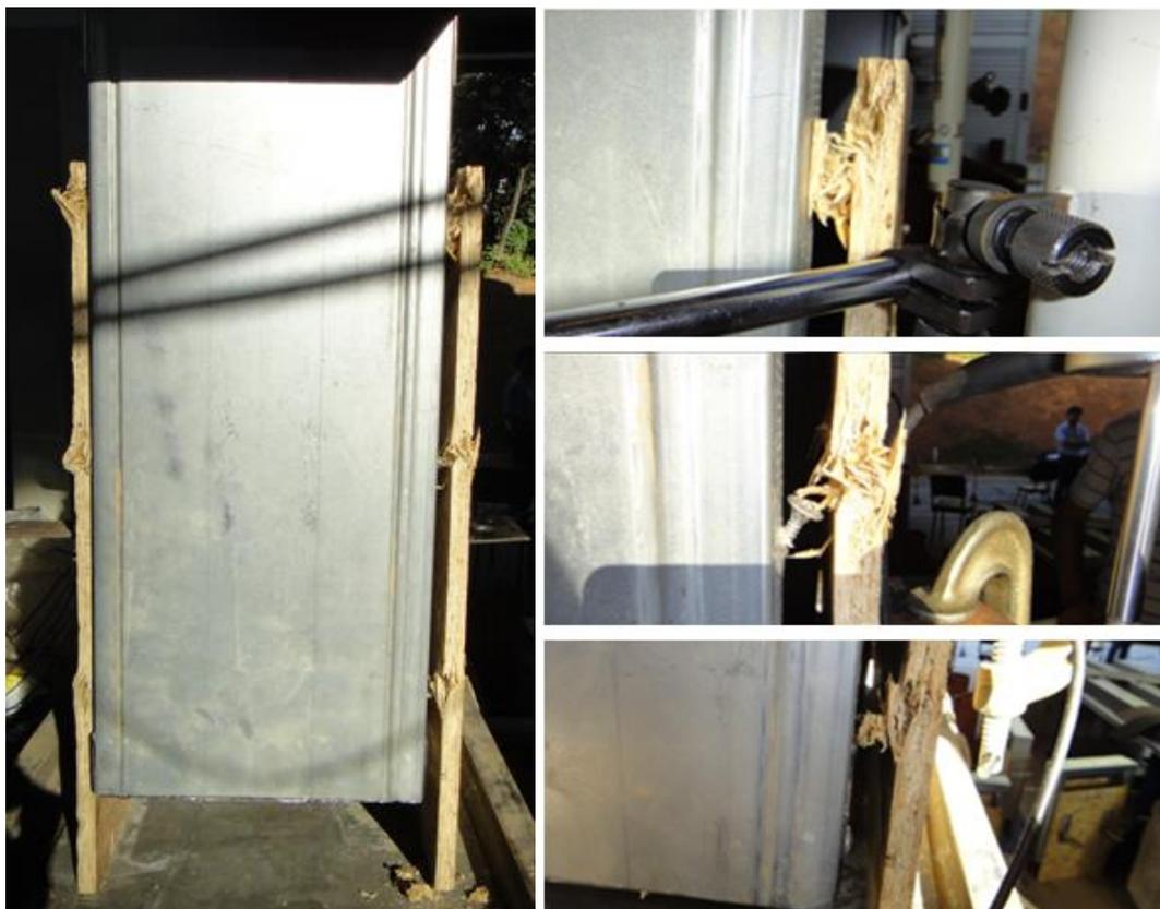
Figura 3.72: Modelo M2B 200 600 150 CP2 - Ruptura por "pull-over" no lado P2D da placa de OSB.
