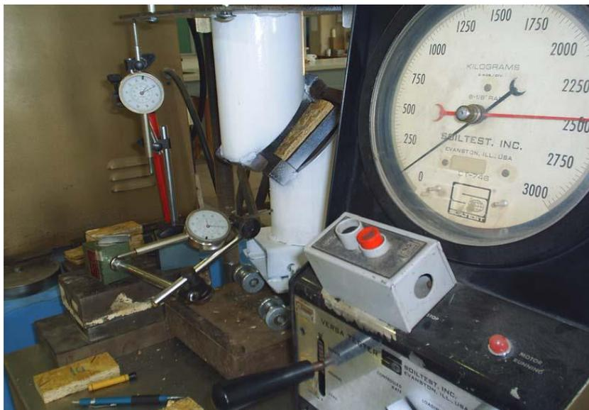
Figura 2.8: Ensaio de cisalhamento à compressão (BASTOS, 2009).
