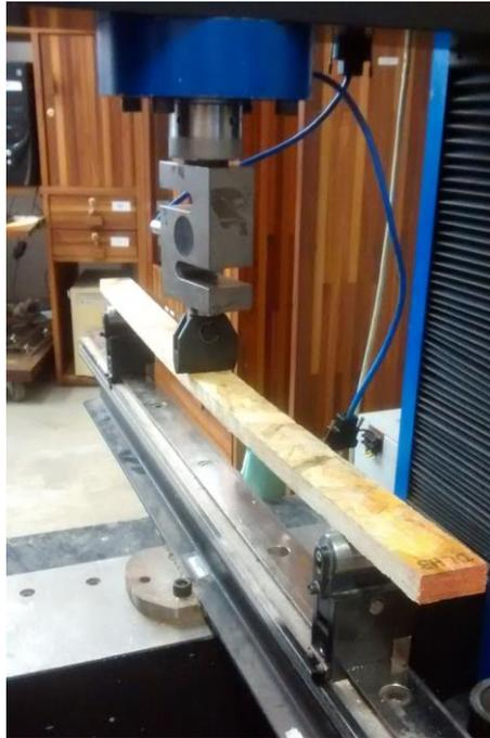
Figura 3.23: Corpo de prova da Série DL posicionado para ensaio, V=40xt.
