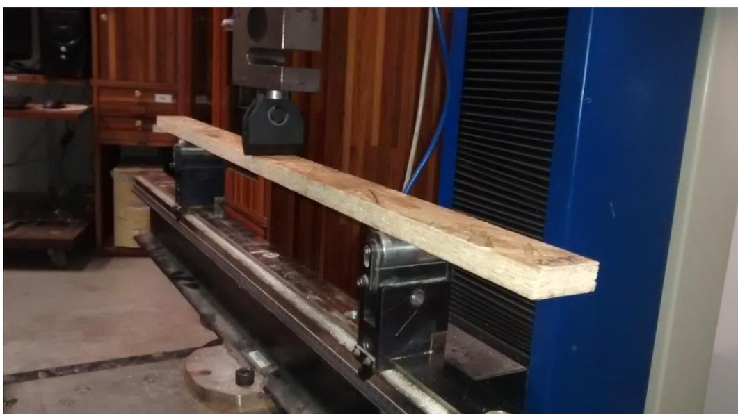
Figura 3.22: Corpo de prova da Série DL posicionado para ensaio, V=32xt.
