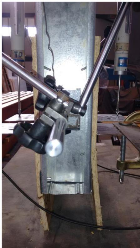
Figura 3.103: Modelo M2A 200 600 150 CP2 - Empenamento nas placas de OSB, interrupção do ensaio.
