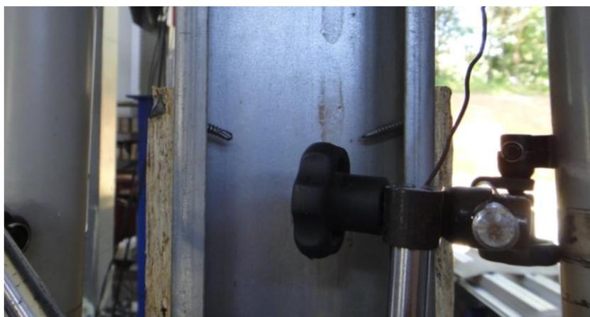
Figura 3.47: Modelo M2B 090 600 150 CP3 - Rotação dos parafusos P1D e P2D.
