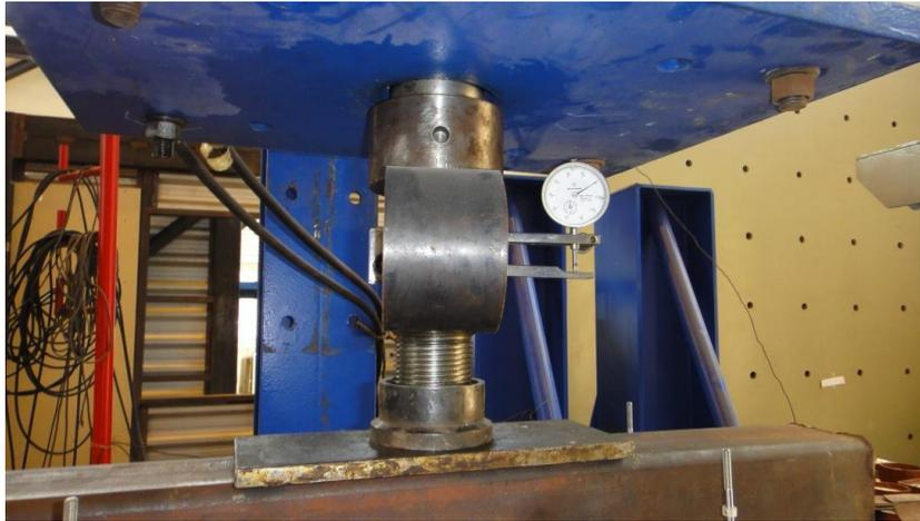
Figura 3.40: Sistema de aplicação e controle de força – Anel dinamométrico.
