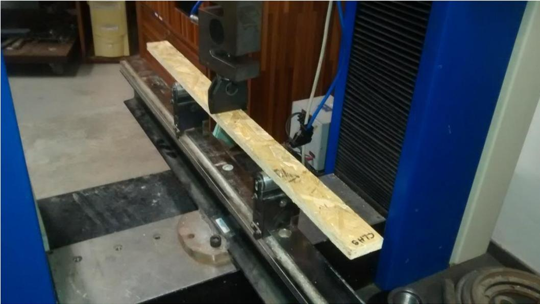
Figura 3.14: Corpo de prova da Série CL posicionado para ensaio, V=24xt.
