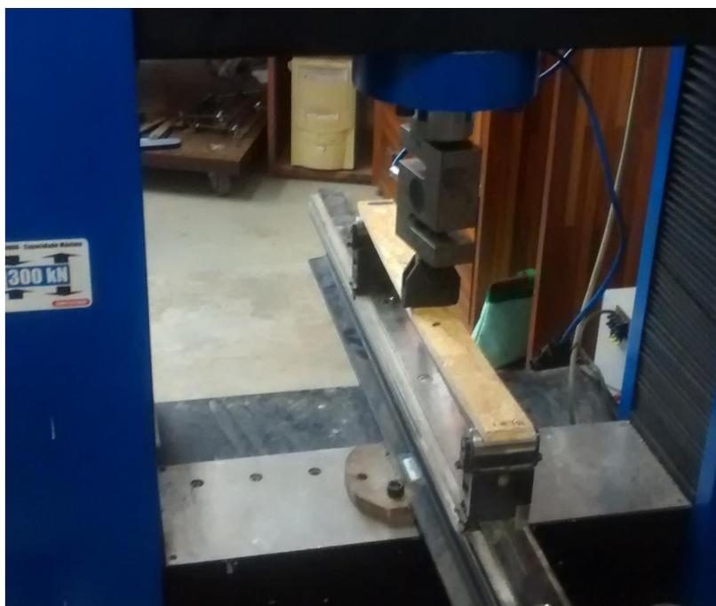
Figura 3.10: Corpo de prova da Série BL posicionado para ensaio, V=48xt.
