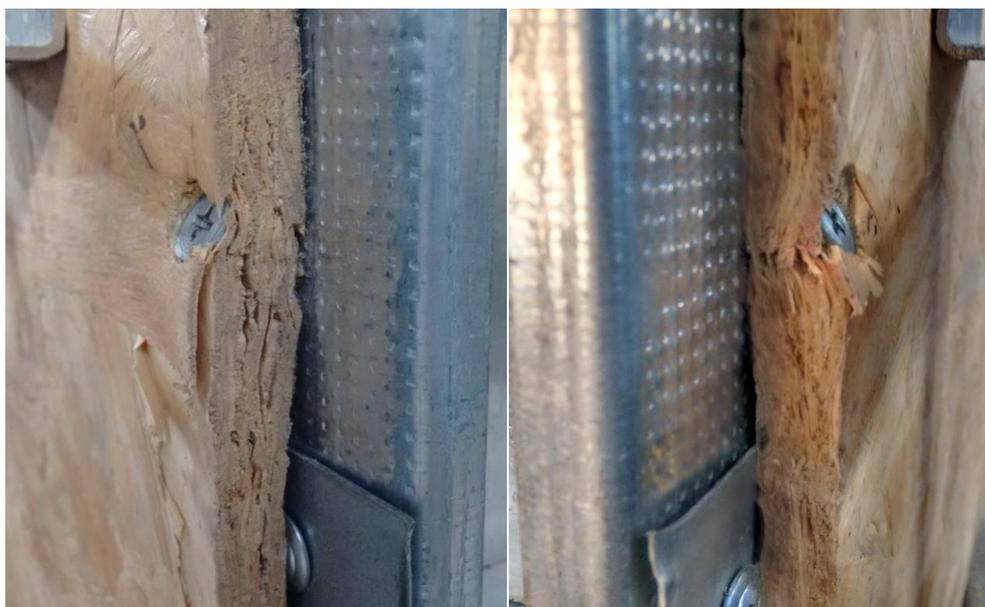
Figura 3.96: Modelo M2A 200 600 150 CP1 - Rotação e tração nos parafusos, ruptura pontual das placas de OSB.
