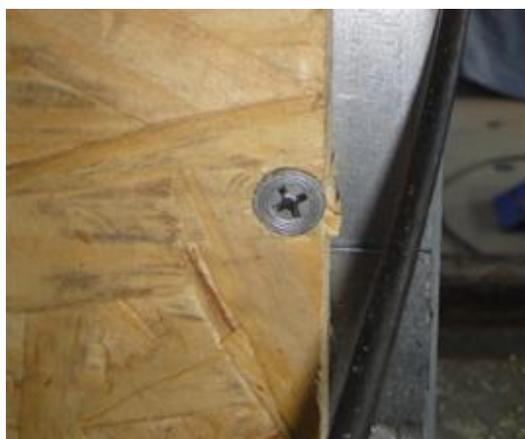
Figura 3.36: Modelo M2A 090 400 300 CP3, parafuso de fixação situado muito próximo à borda da placa de OSB.
