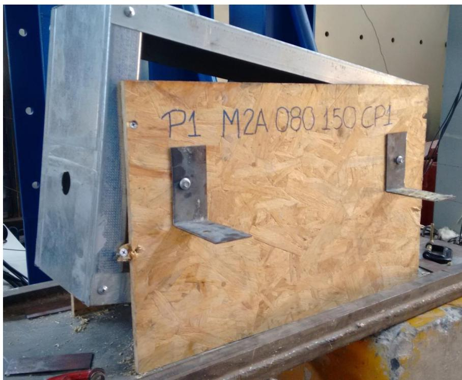
Figura 3.99: Modelo M2A 200 600 150 CP1 - Ruptura do modelo no seu lado esquerdo.
