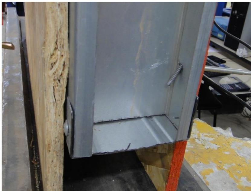
Figura 3.53: Modelo M2B 090 600 150 CP1 - Ruptura pontual da placa de OSB na região dos parafusos e rotação do primeiro parafuso do lado direito P2D.
