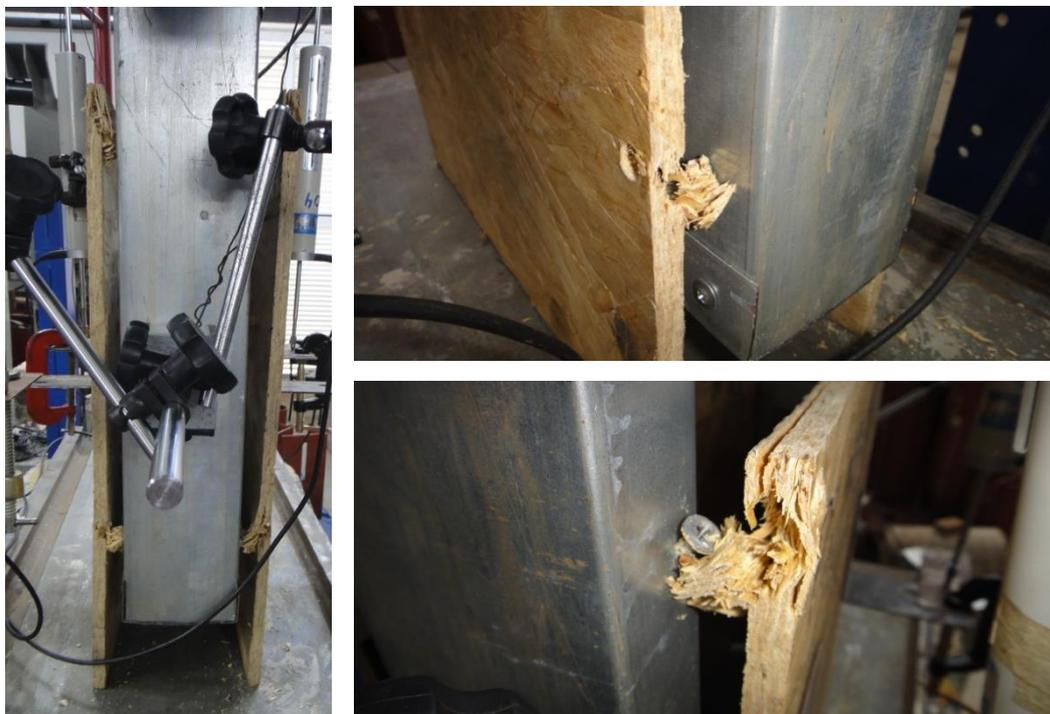
Figura 3.83: Modelo M2A 090 400 300 CP1 - Modo de falha “*pull-over*”.
