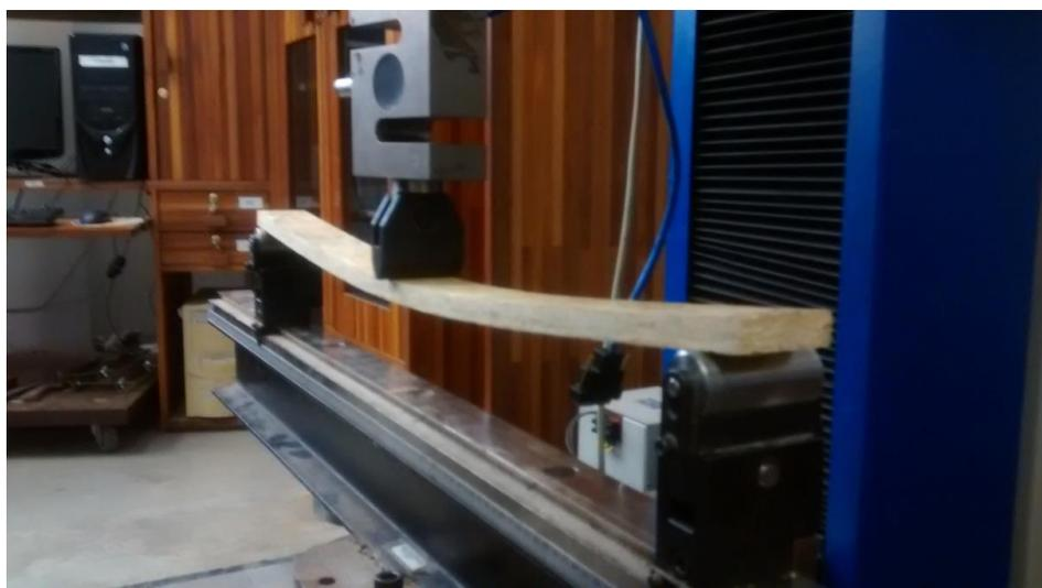
Figura 3.17: Ensaio em andamento de um corpo de prova da Série CL, V=48xt.
