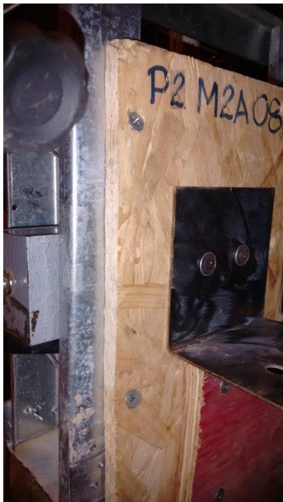
Figura 3.106: Modelo M2A 200 600 150 CP3 - Rotação dos parafusos.
