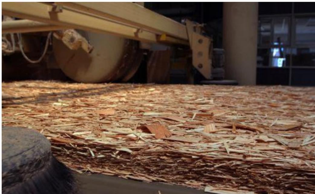
Figura 2.1: Fabricação da placa de OSB. Fonte: site da Global Wood em: <http://www.globalwood.com.br>.
