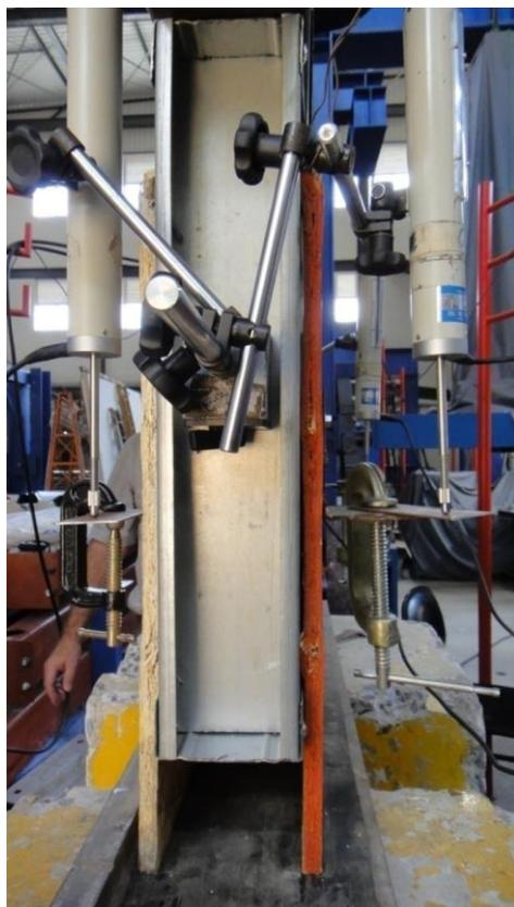
Figura 3.54: Modelo M2B 090 600 150 CP1 - Ruptura pontual da placa de OSB na região dos parafusos no lado direito do modelo (P1D e P2D).
