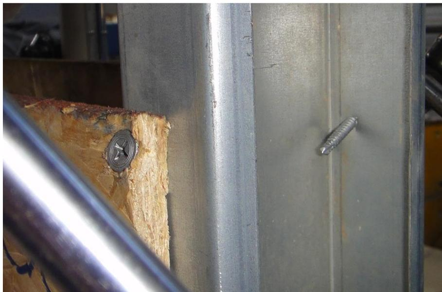
Figura 3.84: Modelo M2A 090 400 300 CP2 - Parafuso fixado muito próximo à borda do OSB.
