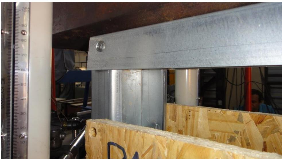
Figura 3.58: Modelo M2B 090 600 150 CP2 - Distorção no perfil do lado esquerdo do modelo (P1E e P2E).
