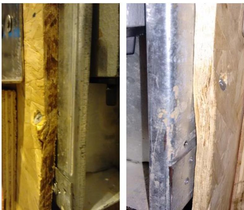
Figura 3.110: Modelo M2A 200 600 150 CP3 - Ruptura pontual das placas de OSB.
