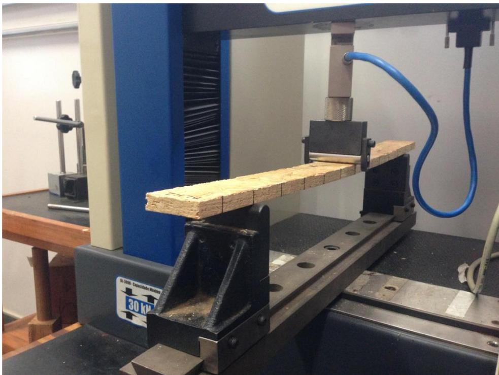
Figura 3.9: Ensaio em andamento de um corpo de prova da Série BL, V=40xt.
