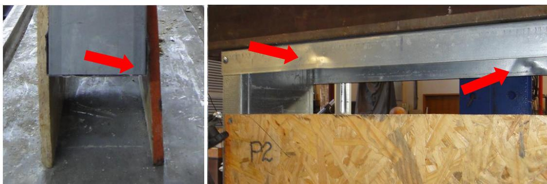
Figura 3.38: À esquerda, empenamento da base (M2A090400300CP3) e à direita, guia deformada (M2B 200 600 150 CP3).
