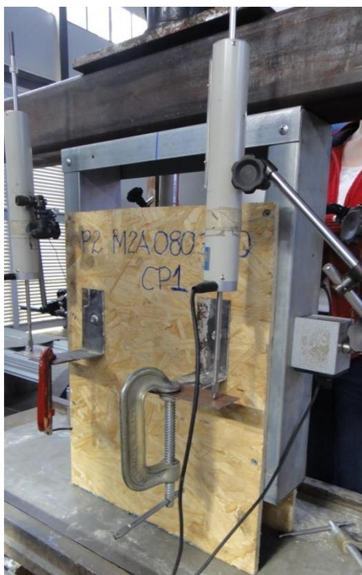
Figura 3.78: Modelo M2A 090 400 300 CP1 - Maior distância entre parafusos e redução na espessura das placas de OSB.
