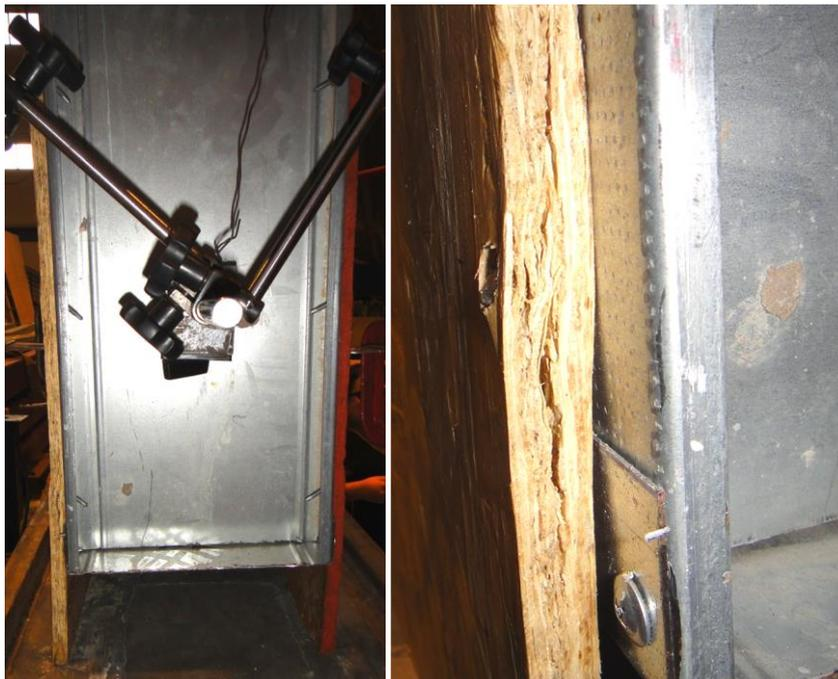
Figura 3.76: Modelo M2B 200 600 150 CP3 - Rotação dos parafusos e ruptura da placa de OSB no lado P2D.
