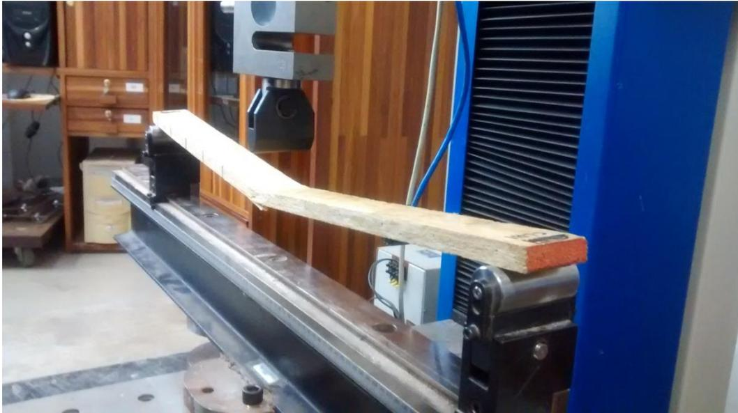
Figura 3.18: Ruptura típica dos CPs - Neste caso CP da Série CL, V=48xt.
