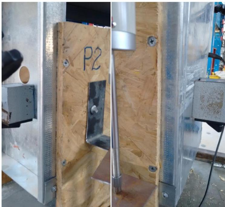
Figura 3.94: Modelo M2A 200 600 150 CP1 - Parafusos fixados próximos à borda das placas de OSB.
