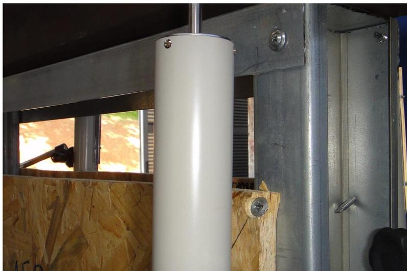
Figura 3.48: Modelo M2B 090 600 150 CP3 – Parafuso superior P1D próximo à borda da placa.
