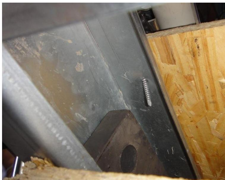
Figura 3.59: Modelo M2B 090 600 150 CP2 - Rotação do parafuso superior.
