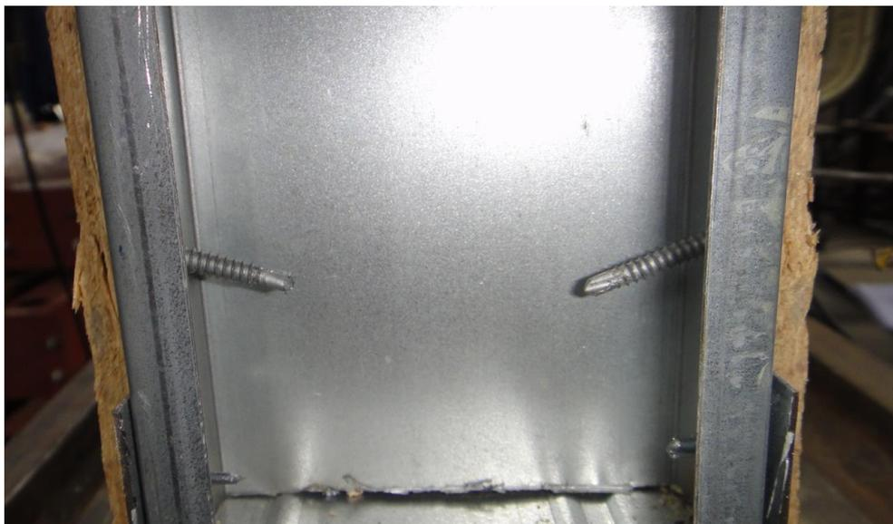
Figura 3.81: Modelo M2A 090 400 300 CP1 - Rotação dos parafusos e ruptura pontual da placa de OSB na região dos parafusos.
