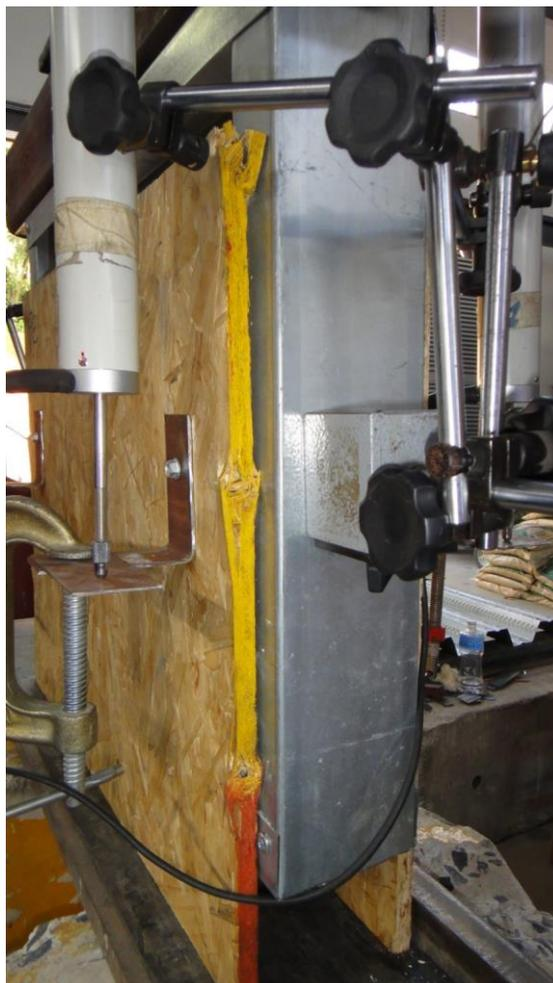
Figura 3.60: Modelo M2B 090 600 150 CP2 - Ruptura pontual da placa de OSB na região dos parafusos.
