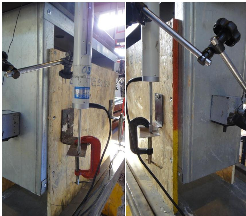
Figura 3.71: Modelo M2B 200 600 150 CP2 - Rotação dos parafusos no lado P2D à esquerda e P1D à direita.
