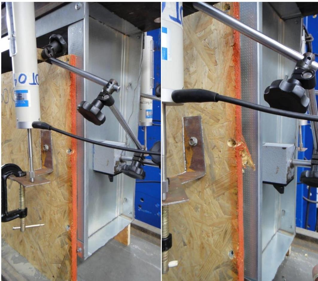
Figura 3.64: Modelo M2B 200 600 150 CP1 - À esquerda, parafusos tracionados e à direita, ruptura pontual da placa de OSB na região dos parafusos no lado direito do modelo P1D.
