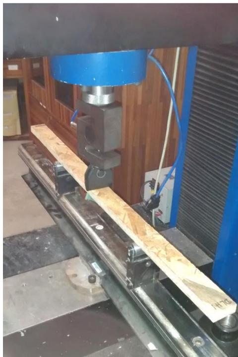
Figura 3.21: Corpo de prova da Série DL posicionado para ensaio, V=24xt.
