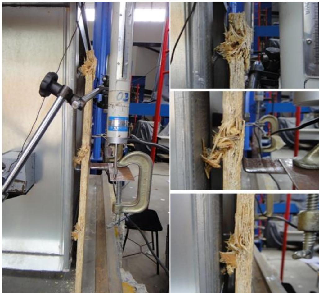
Figura 3.66: Modelo M2B 200 600 150 CP1 - Modos de falha na placa de OSB P2D.
