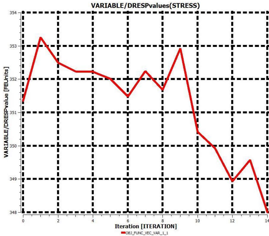
Figura 4.64: Níveis máximos de tensões computados ao longo do processo iterativo de otimização para a análise linear estática do suporte de chassi veicular.
