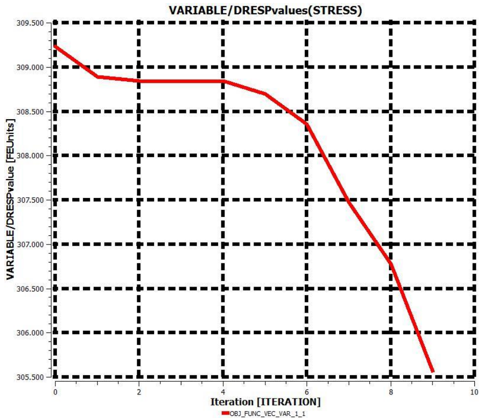
Figura 4.34: Níveis máximos de tensões computados ao longo do processo iterativo de otimização para o modelo linear elástico com amortecimento “A”.
