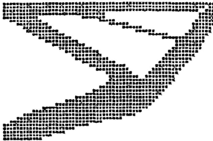
Figura 4.8: Topologia ótima da viga em balanço obtida pela solução de Xie e Steven (1994b) para o caso de carregamento 2.
