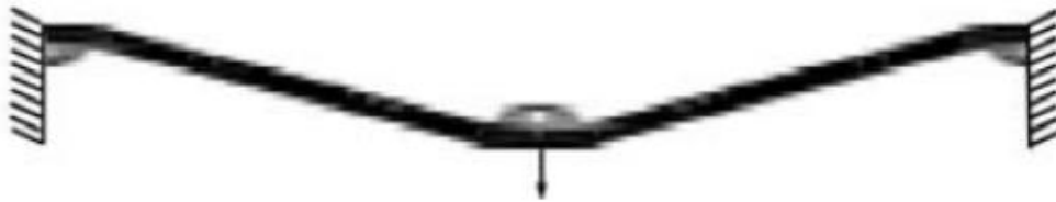
Figura 4.45: Topologia ótima obtida pela solução de Jung e Gea (2004) para a análise não linear em condição estática de carregamento.
