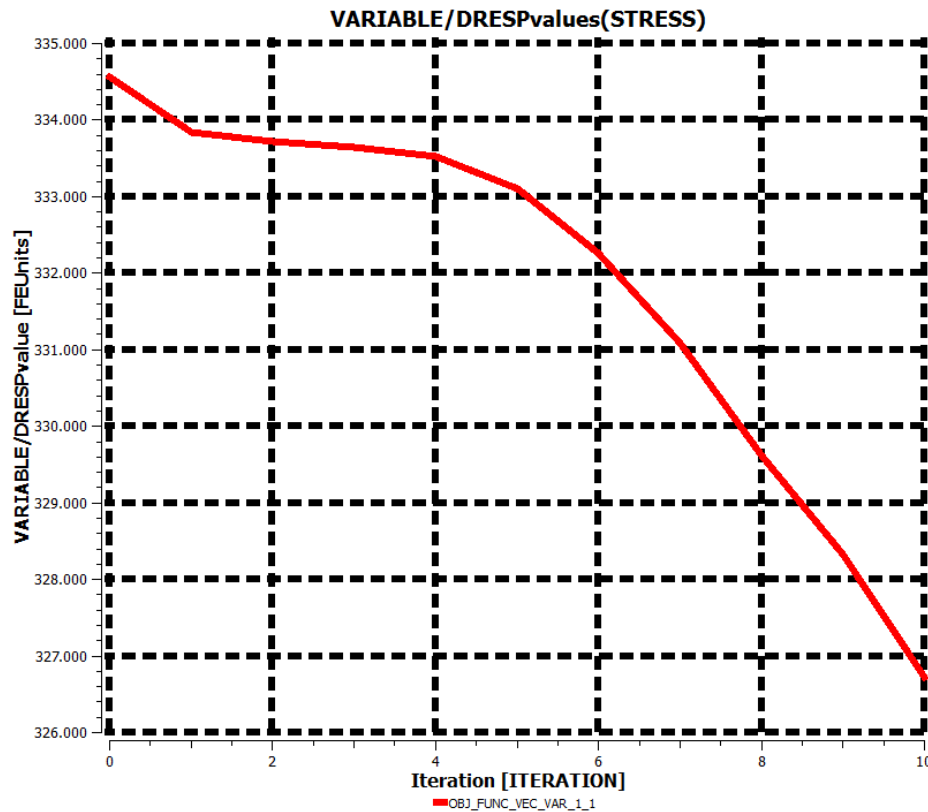
Figura 4.38: Níveis máximos de tensões computados ao longo do processo iterativo de otimização para o modelo linear elástico com amortecimento “B”.
