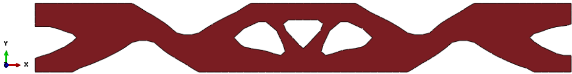
Figura 4.33: Topologia ótima obtida pelo Tosca® para a análise linear elástica com taxa de amortecimento “A”.
