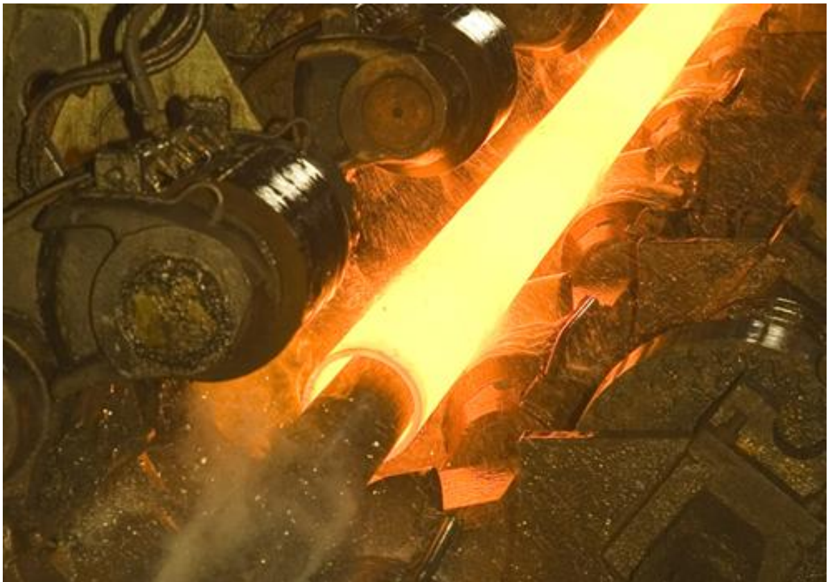
Figura 1.5 – Laminação de perfis tubulares circulares ( http://www.vallourec.com/countries/brazil , 2015)
