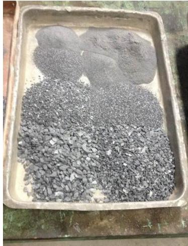
Figura 3.6- Distribuição granulométrica do agregado utilizada nas argamassas.
