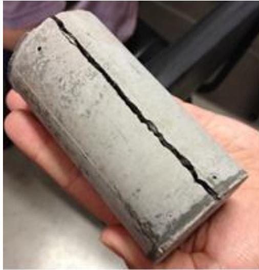
Figura 4.7 – Aspecto do corpo de prova após ensaio de resistência à tração.
