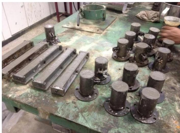
Figura 3.11 - Moldagem dos corpos de prova
