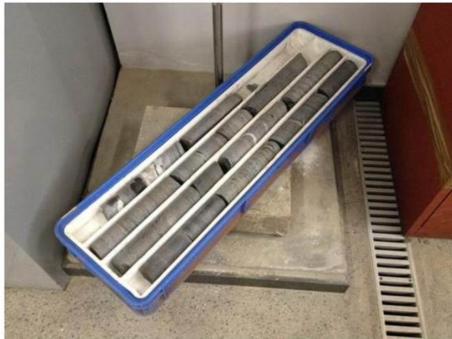
Figura 3.3 - Estado de conservação dos testemunhos de sondagem do complexo da UHE de Irapé.
