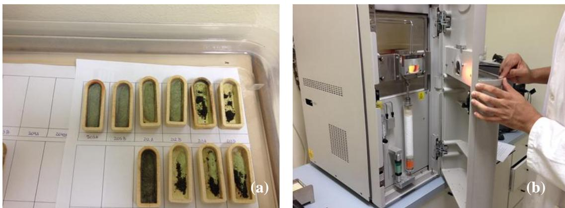
Figura 3.8 - (a) Amostras de agregado para o ensaio de combustão direta (b) Equipamento LECO utilizado.
