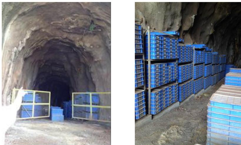
Figura 3.1- Testemunhos de sondagem - Janela de acesso de escavação dos extravasores - UHE de Irapé.
