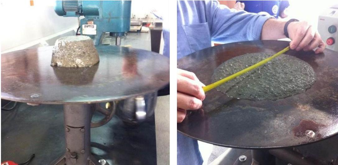
Figura 3.10 - Ensaio de consistência da argamassa no estado fresco conforme a norma NBR 7215(ABNT, 1997)
