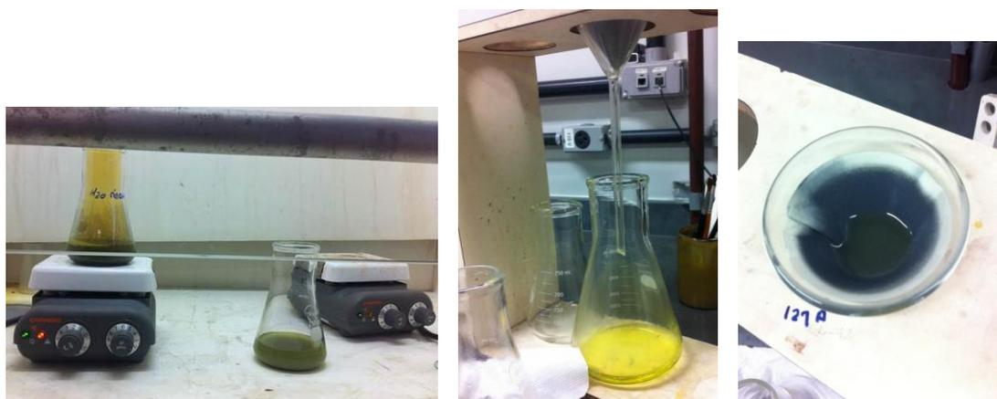
Figura 3.9 - Dissolução da pirrotita do agregado em ácido clorídrico
