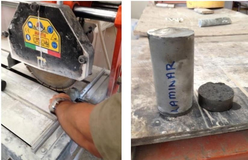
Figura 3.17 - Corte dos corpos de prova para os ensaios de microestrutura
