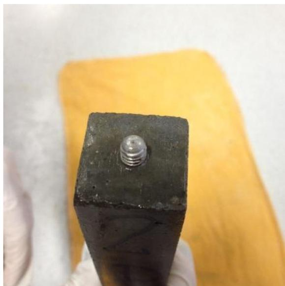
Figura 3.12 – Pino de aço instalado no corpo de prova.
