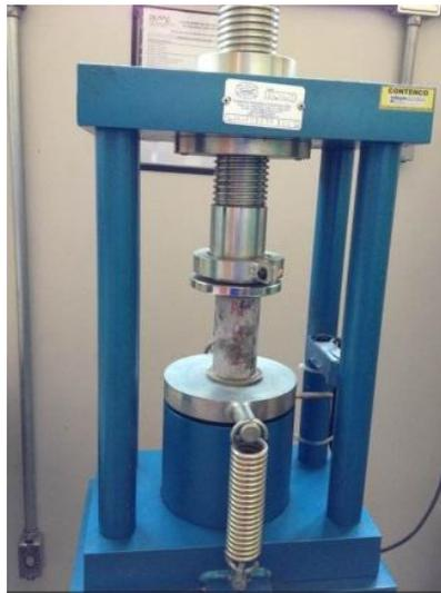
Figura 3.15 - Ensaio de resistência à compressão.
