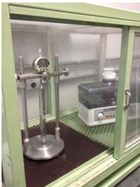
Figura 3.14 – Local de realização das medições de expansão.
