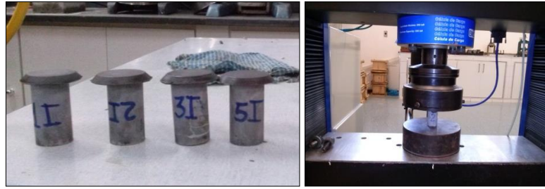
Figura: 3.8: Corpos de prova capeados com enxofre e ensaio de resistência à compressão.
