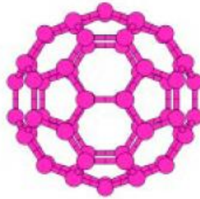
Figura 2.6: Fulereo C_{60} , similar a uma bola de futebol. (Fonte: CAPAZ e CHACHAM, 2003)
