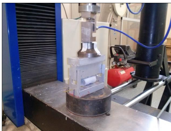
Figura: 3.9: Ensaio de tração por compressão diametral.
