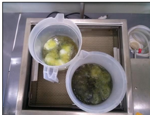
Figura 3.10: Ensaio de resistência ao ataque do ácido “ mud regular acid ” em câmara ultrassônica.
