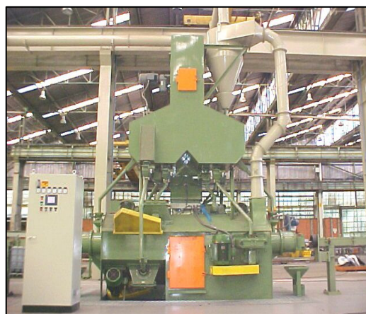
Figura 3.9 - Decapadora para jateamento de granalha
