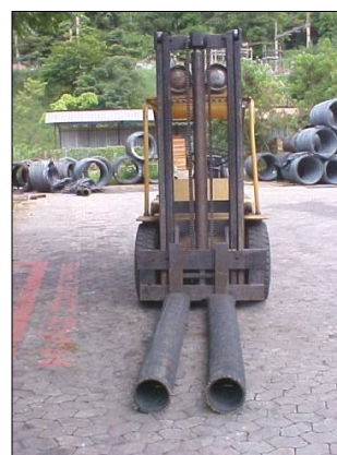
Figura 3.5 - Empilhadeira com lanças protegidas para movimentação de fio máquina
