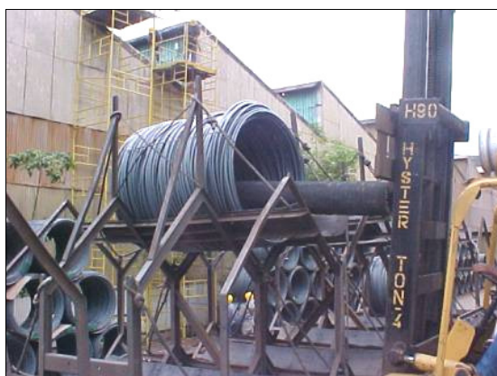
Figura 3.4 - Carreta adaptada para transporte de fio máquina em “berços” individualizados
