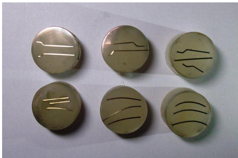
Figura 4.6 - Amostras preparadas para a microscopia
