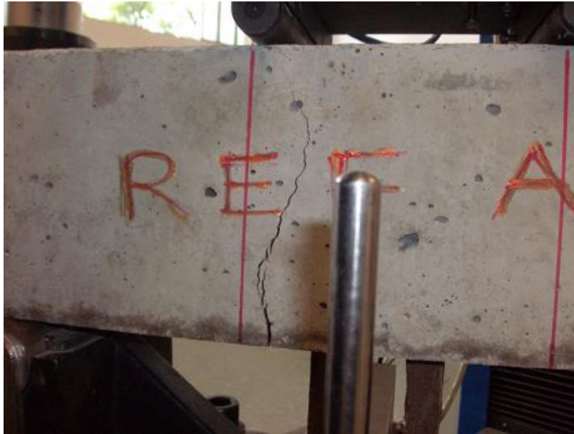
Figura 5.31 - Fissuração do concreto de referência após o ensaio de flexão
