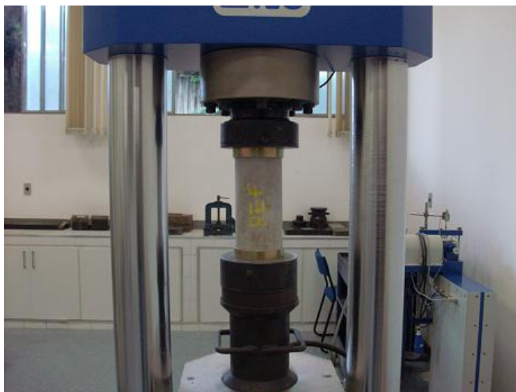
Figura 4.21 - Ensaio de resistência à compressão
