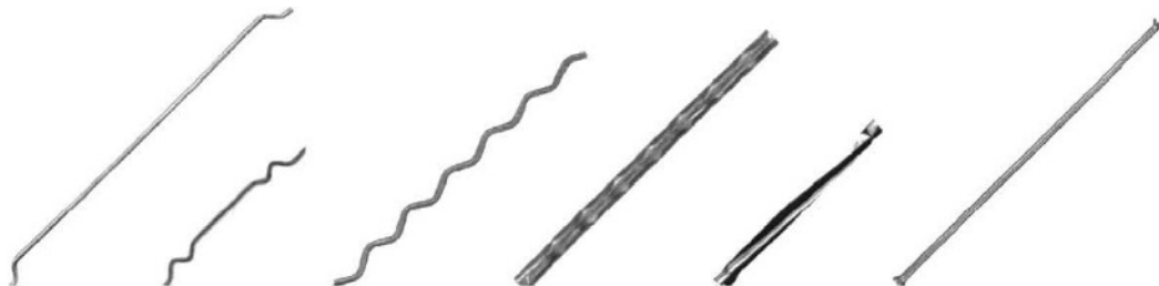
Figura 3.3 - Diferentes tipos de fibras curtas de aço (HOLSCHEMACHER et al. , 2010)
