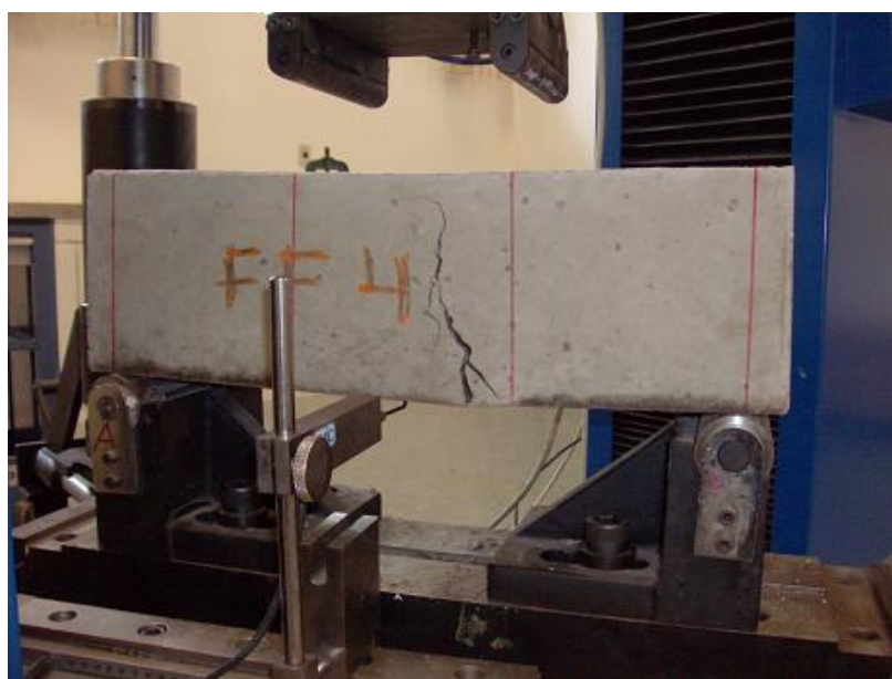
Figura 5.37 - Fissuração do concreto reforçado com a fibra FF4 após o ensaio de flexão
