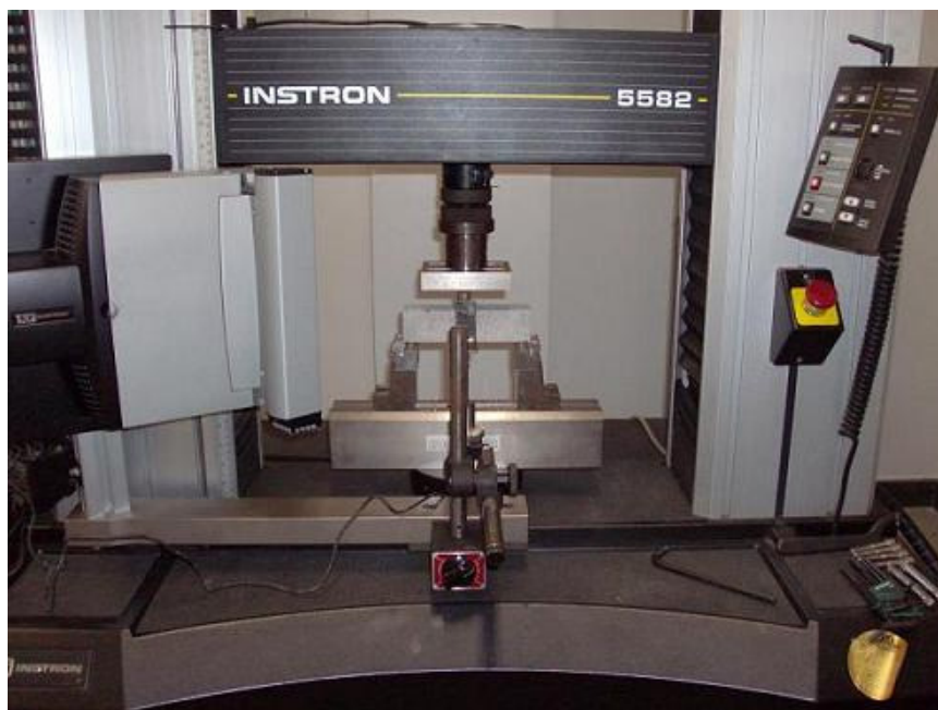
Figura 4.17 - Equipamento de ensaio universal durante o experimento
