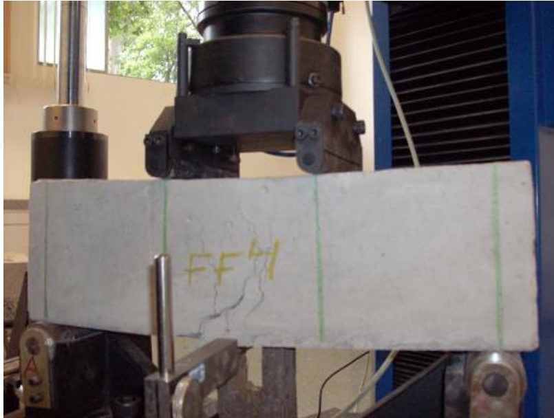
Figura 5.49 - Fissuração do concreto reforçado com a fibra FF4 aquecido após o ensaio de flexão
