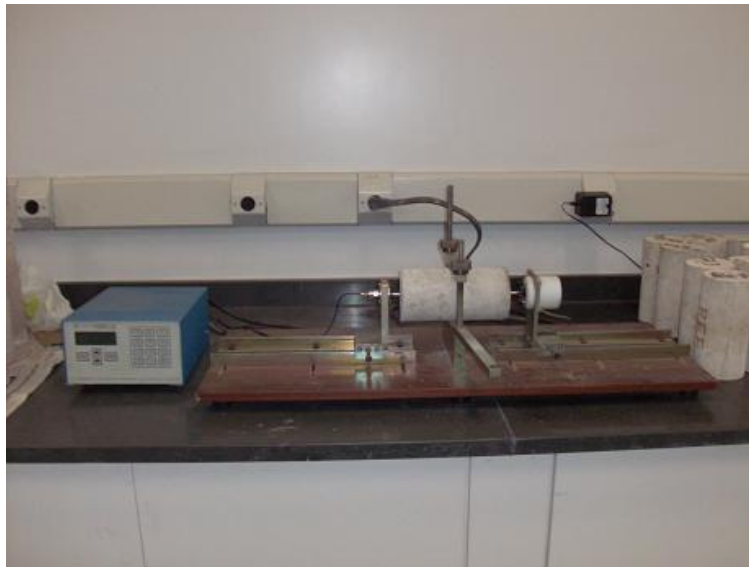
Figura 4.12 - Ensaio de módulo de elasticidade dinâmico longitudinal
