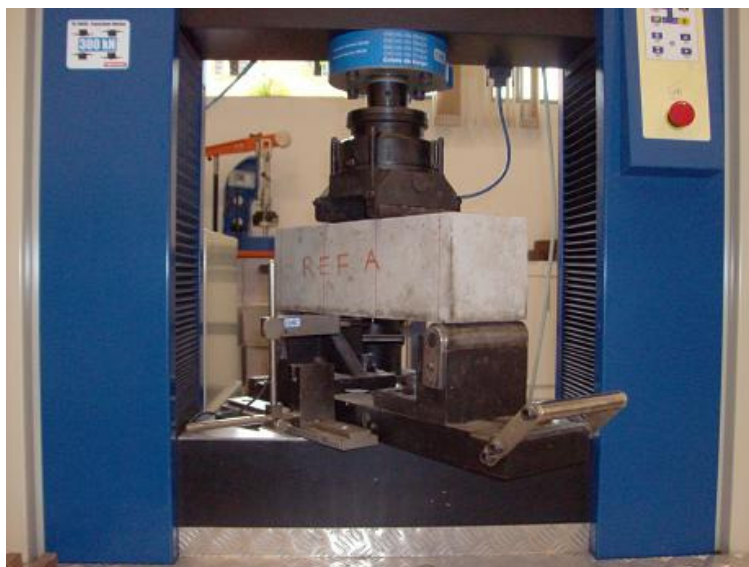
Figura 4.23 - Ensaio de resistência à tração na flexão
