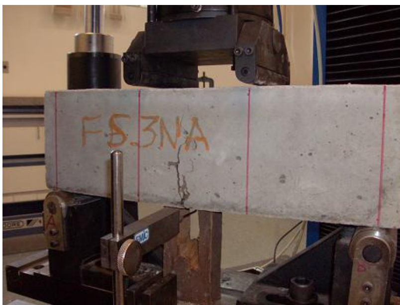
Figura 5.33 - Fissuração do concreto reforçado com a fibra FS3N após o ensaio de flexão
