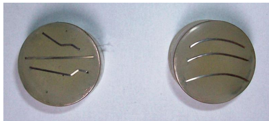
Figura 5.25 - Extremidades das fibras antes e após aos ensaios
