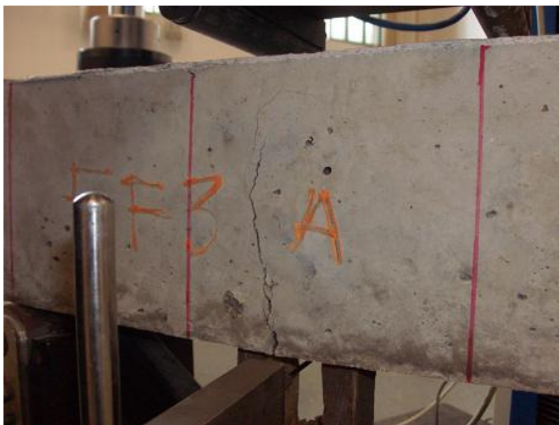
Figura 5.35 - Fissuração do concreto reforçado com a fibra FF3 após o ensaio de flexão
