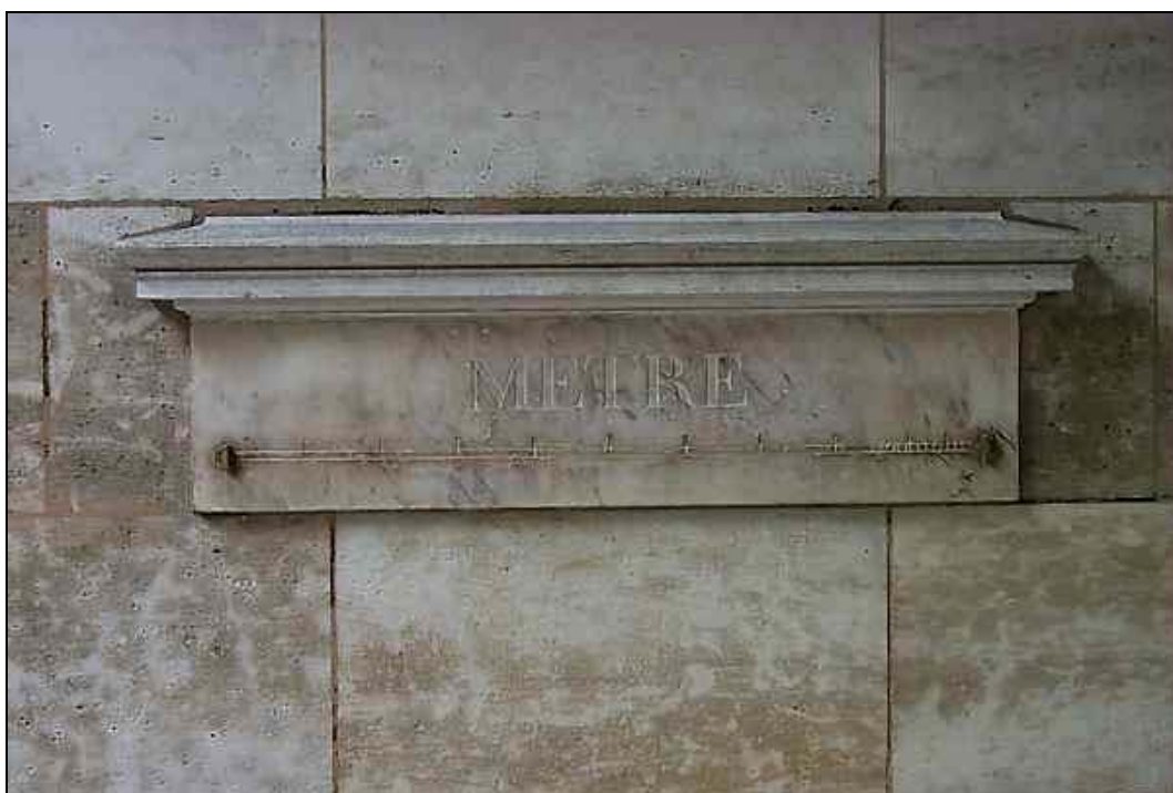
Figura 3: O metro-padrão instalado no número 36 da rua de Vaugirad, em Paris. O governo francês instalou cerca de 16 unidades nas áreas mais movimentadas de Paris entre 1796 e 1797.
