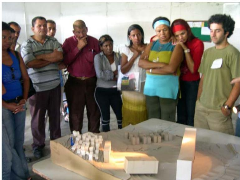
**Imagem 27: Ensaio de Insolação sobre a Maquete Física**
