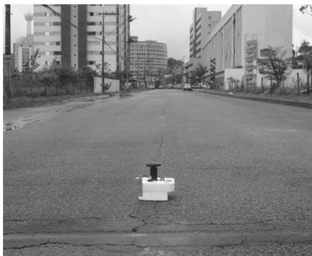
FIGURA 33 - Aparato para fotografia FVC locado no eixo da via
