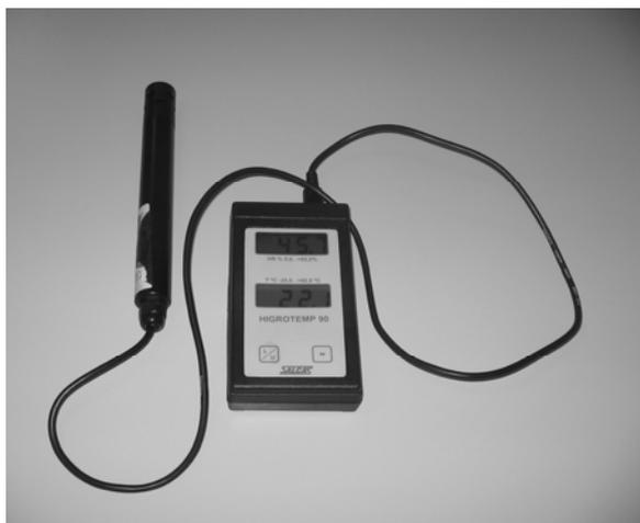
FIGURA 29 - Equipamento Termohigrometro digital, marca Salcas, modelo Higrotemp.
