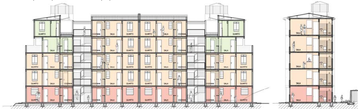
FIGURAS 82a e 82b - Conjunto Santa Rosa II – Blocos 5 e 6 - Corte BB/Corte EE – Escala 1:500. Fonte: arquivo particular da equipe de assessoria técnica.
