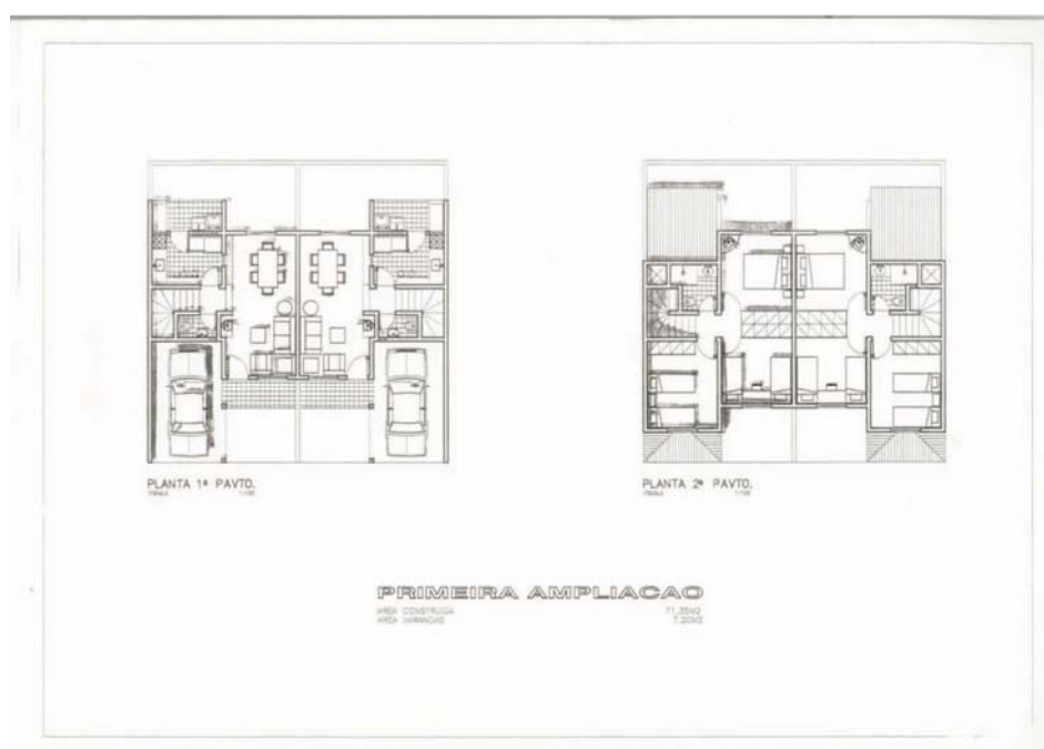
FIGURA 54 Conjunto Residencial 3- Estudo preliminar: plantas primeira ampliação Fonte: Imagens digitalizadas a partir dos originais cedidos pelos arquitetos em outubro de 2008
