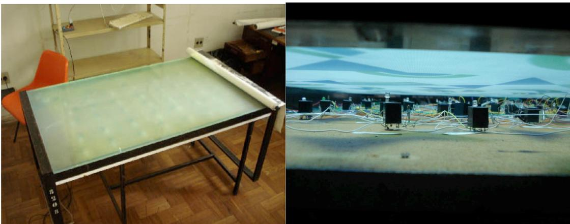
FIGURA 19 – [Vistas da mesa: Superior e Lateral, com os 48 relés e leds. Interface desenvolvida por Mateus van Stralen em 2008]
