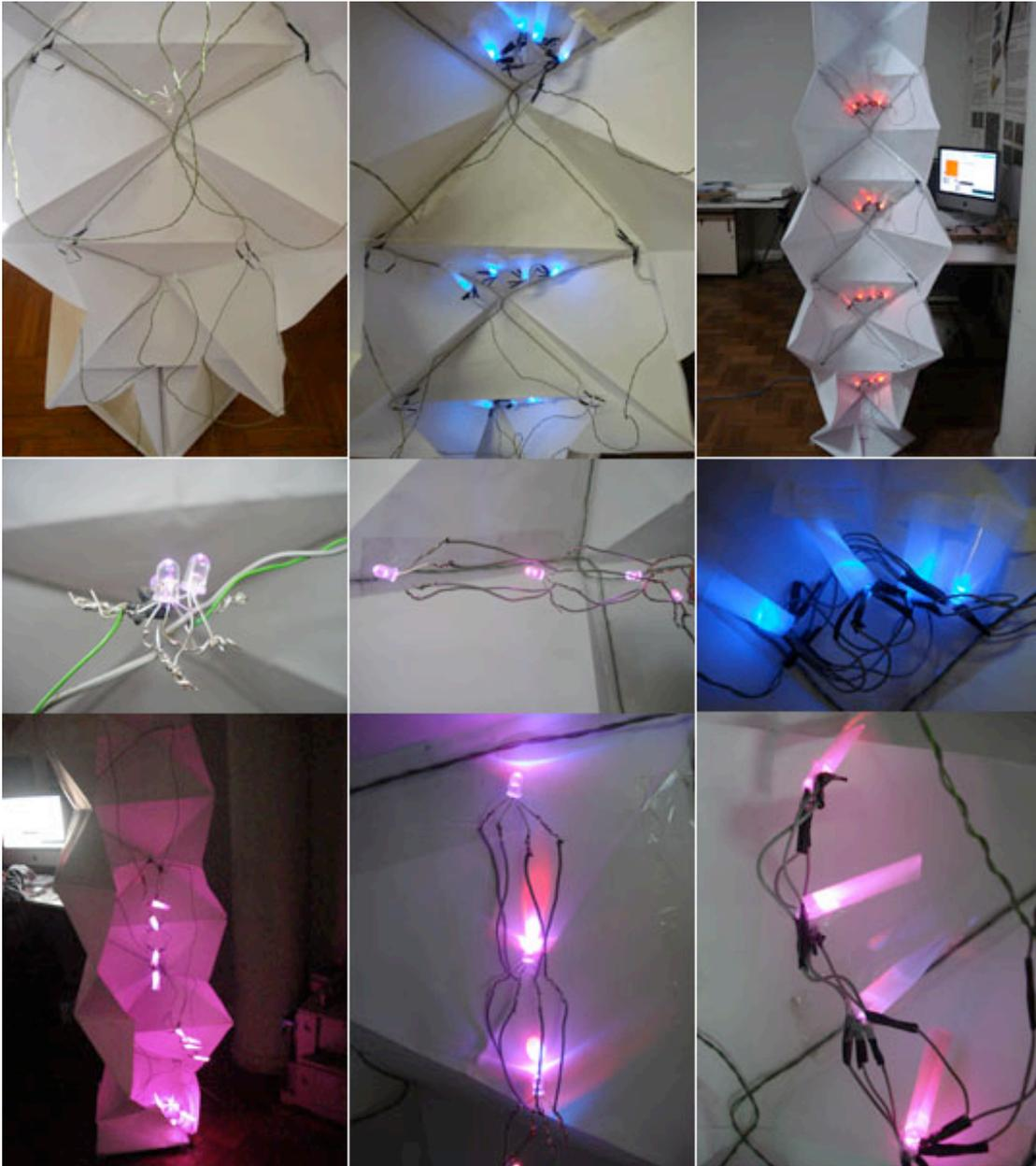
FIGURA 42 – [Imagens de inserção dos leds RGB e da fiação no interior do origami. Parte do Estudo experimental 3, desenvolvido pela autora e pelos bolsistas de iniciação científica do LAGEAR em 2009]
