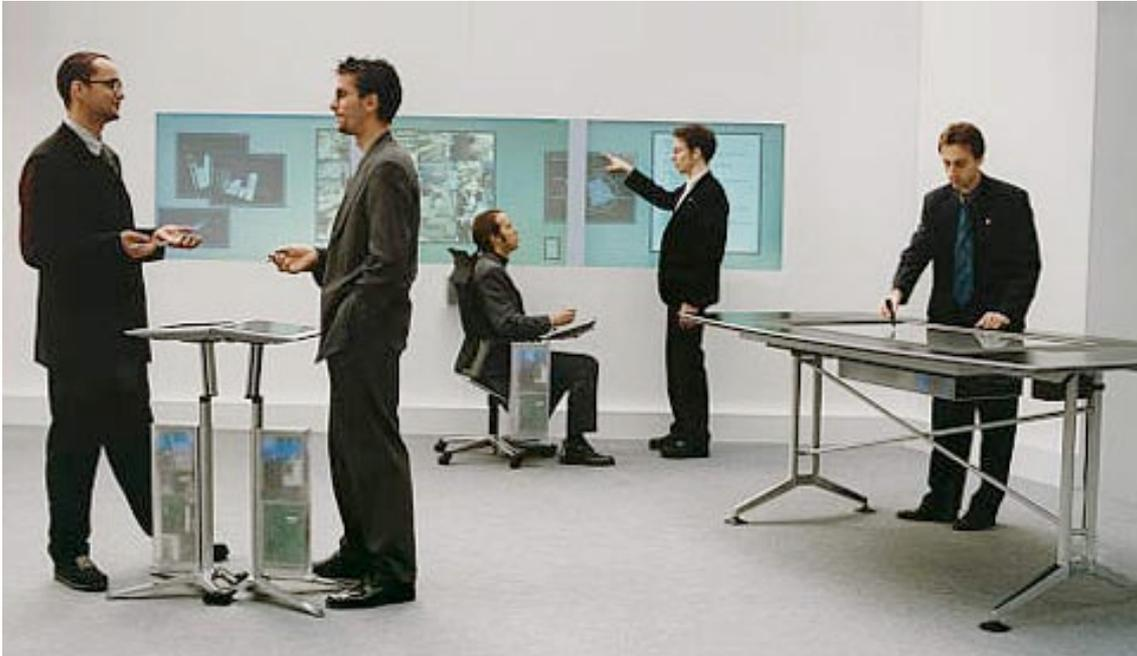
FIGURA 9 - [DynaWall e InteracTable. Desenvolvidos no Fraunhofer Institute, Alemanha, 1999, como parte do projeto Roomware, de Streitz, Prante et al.]
