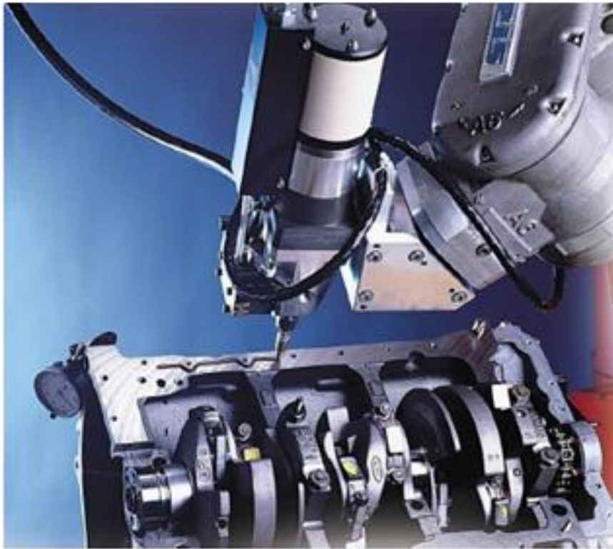
Figura 2-4. Vedação utilizando silicone (dos SANTOS, 2007).
