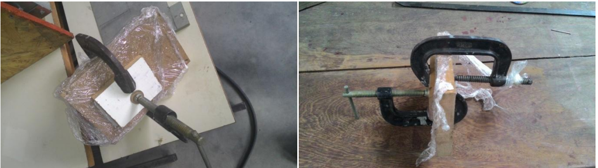
Figura 3-10. Processo de confecção dos corpos de prova para o DMA.
