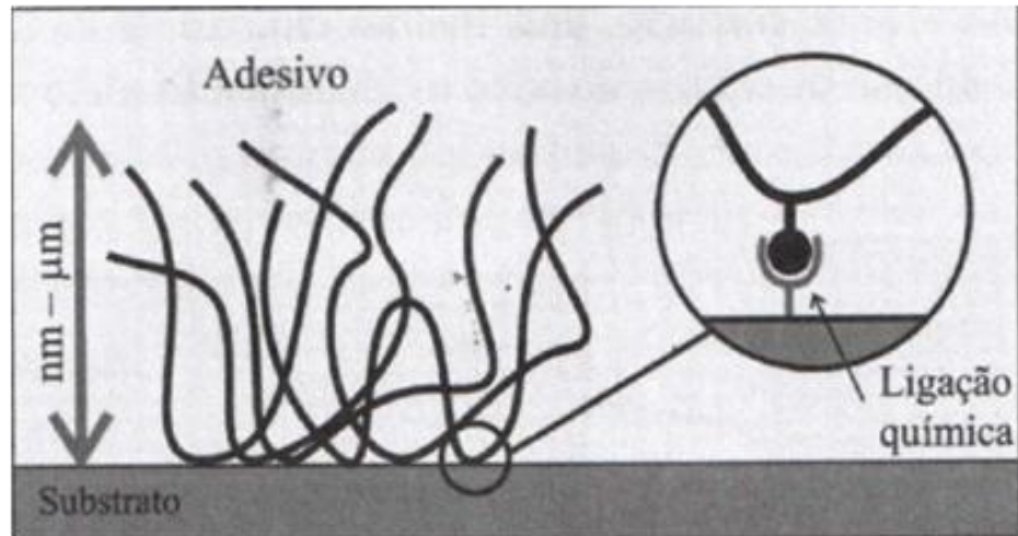
Figura 2-6. Teoria da adsorção química em esquema (da SILVA et al., 2007).
