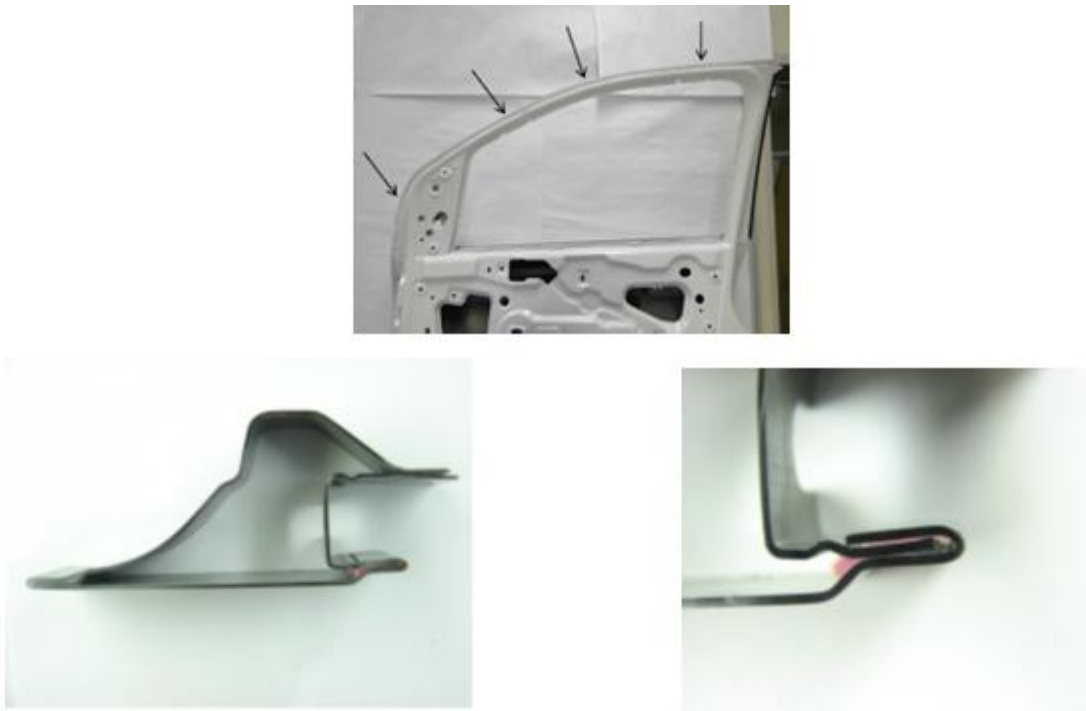
Figura 1-3. Componente porta e seções transversais evidenciando a grafagem e o adesivo aplicado (HOEHNE, 2013).
