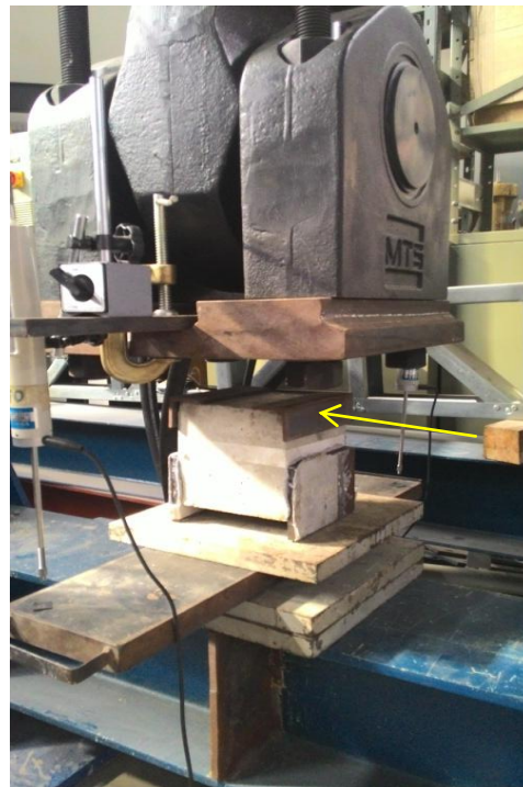
Figura 4-4. Ensaio do modelo D1, a seta amarela indica a presença de uma cantoneira de aço para concentrar a tensão na região de colagem.
