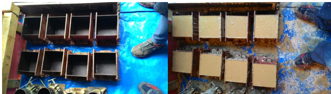
Figura 3-7. Moldes utilizados para concretagem.
