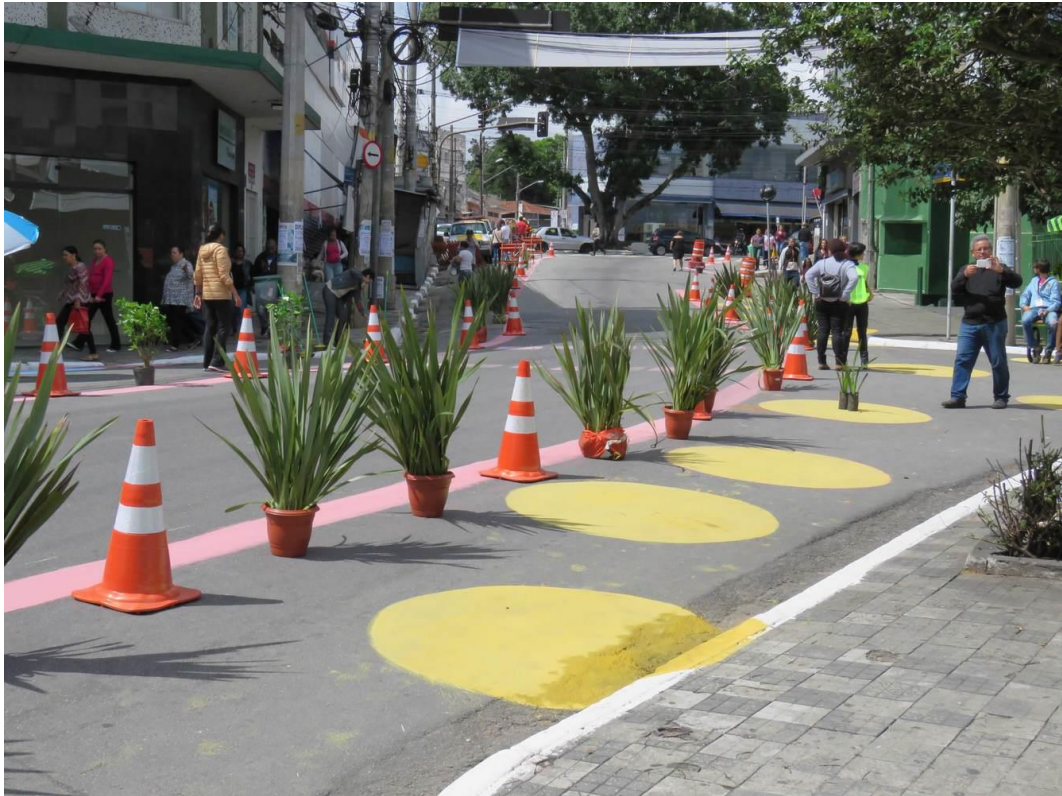
Figura 34: Estreitamento de via com urbanismo tático na praça Getúlio Vargas Filho, São Paulo Fonte: Urb-i (2016)
