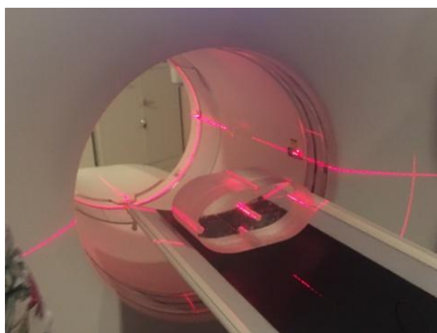
Figura 4.2 Vista frontal do posicionamento do objeto simulador de tórax pediátrico no gantry.
