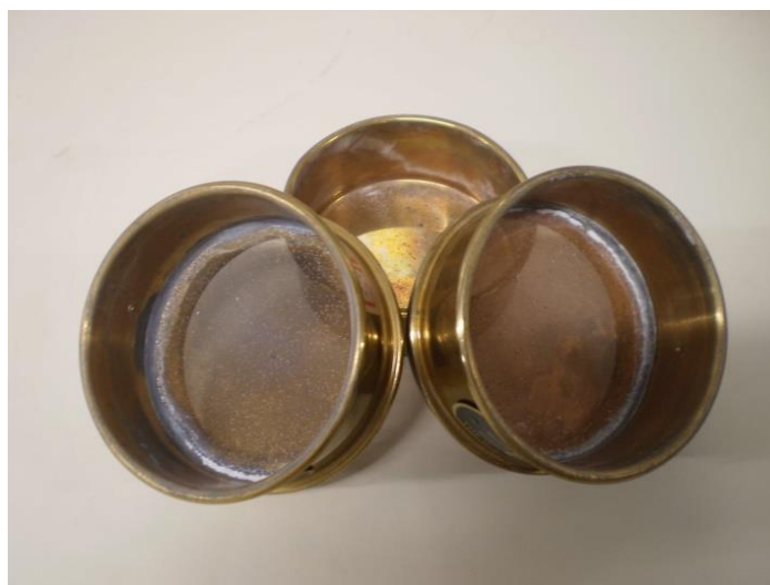
Figura 3.13 Peneiras padrão nº 80, nº 200 e base coletora.
