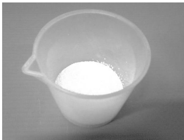
Figura 3.12 Amostras de compósitos de cálcio.
