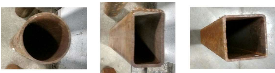
Figura 3.1- Seções típicas de perfis tubulares Fonte: Autor
