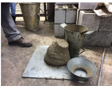
Figura 4.9 - Verificação do Slump do concreto convencional.
