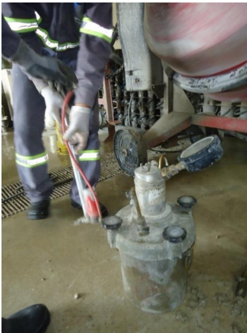
Figura 4.8 - Equipamento para leitura do teor de ar incorporado, 2017.
