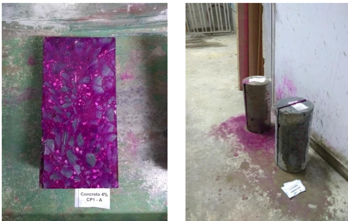
Figura 5.18 - Leitura da frente de carbonatação após aplicação de solução de fenolftaleína, 2018. a) parte interna; b) parte externa
