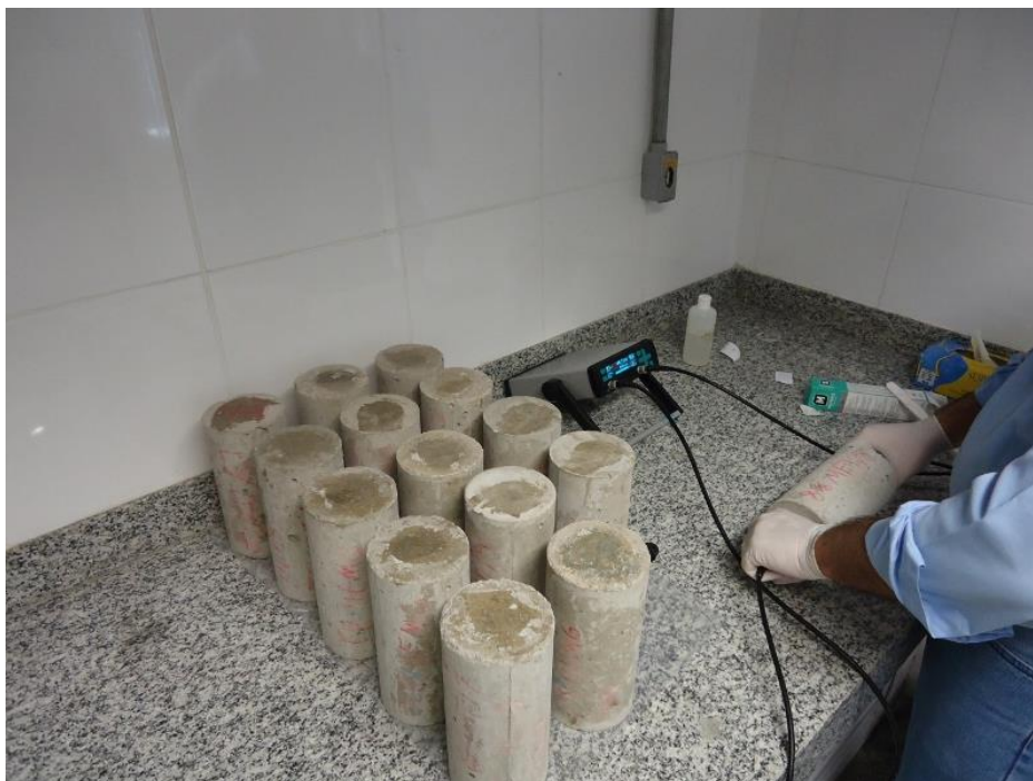
Figura 4.22 - Ensaio de ultrassom com equipamento Pundit Lab (+) da PROCEQ.
