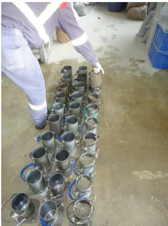
Figura 4.11 - Moldagem de corpos de prova cilíndricos, 2017.
