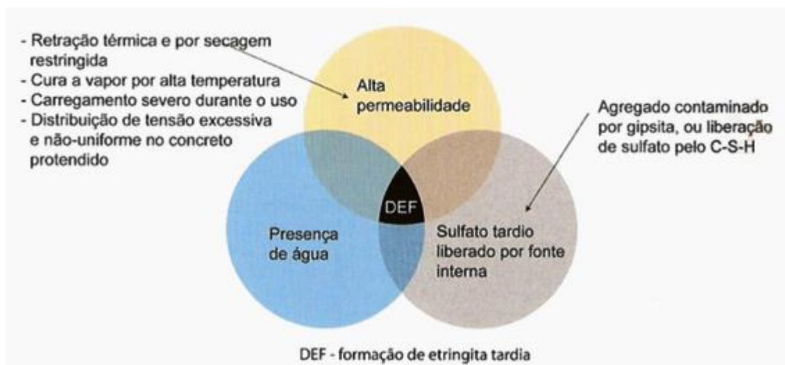
Figura 3.11 - Enfoque holístico para expansão e fissuração por formação de etringita tardia.
