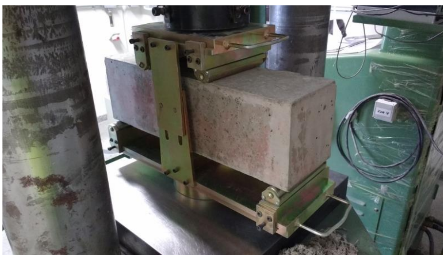
Figura 4.21 - Dispositivo auxiliar para realização do ensaio de tração na flexão, 2017.
