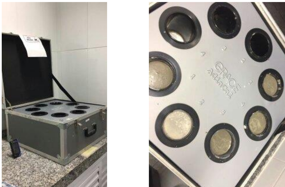
Figura 4.7 - Equipamento do ensaio de calorimetria e amostras preparadas. Fonte: LafargeHolcim, 2017.
