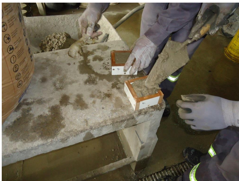
Figura 4.12 - Moldagem dos corpos de prova para ensaio de abrasão, 2017.
