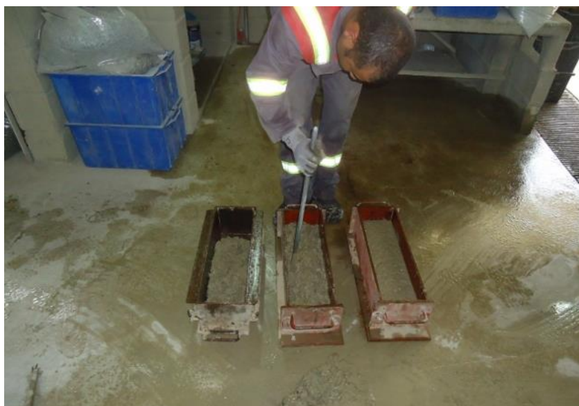
Figura 4.10 - Moldagem de corpos de prova prismáticos, 2017.
