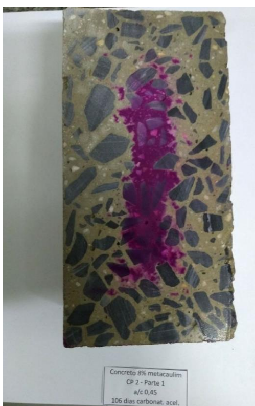
Figura 4.27 - Fotografia da seção de corpo-de-prova com 8% de metacaulim, após realização do ensaio de carbonatação acelerada.
