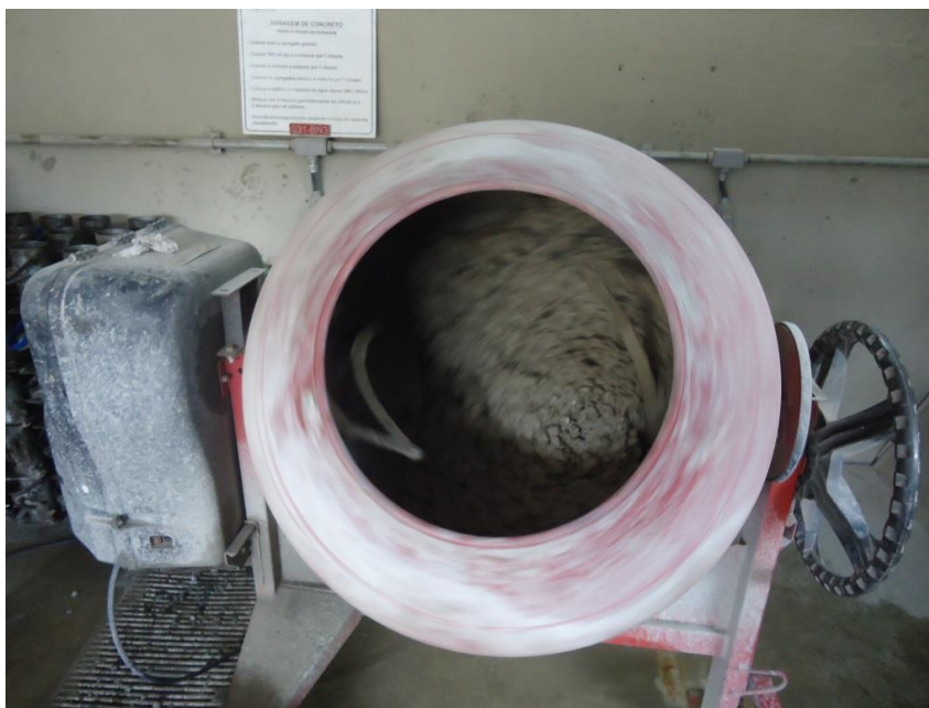
Figura 4.5 - Avaliação visual da mistura do concreto em fase de homogeneização, 2017.
