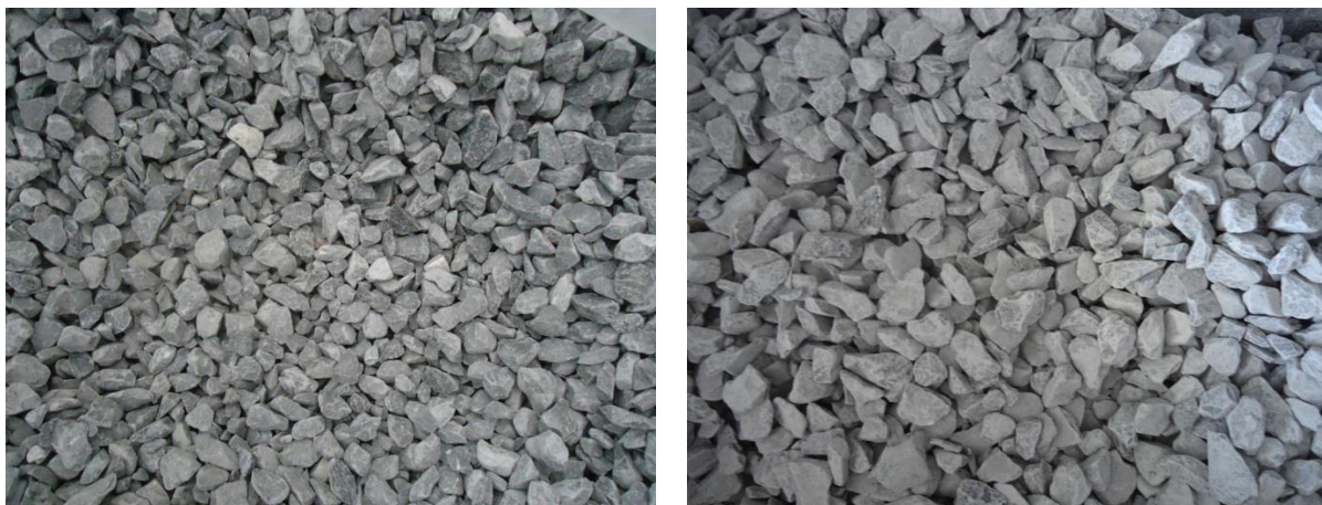
Figura 5.6 - Aspectos visuais das brita 0 e 1 de calcário. Fonte: LafargeHolcim, 2017.
