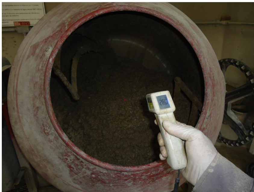
Figura 4.6 - Medição da temperatura do concreto homogeneizado, 2017.
