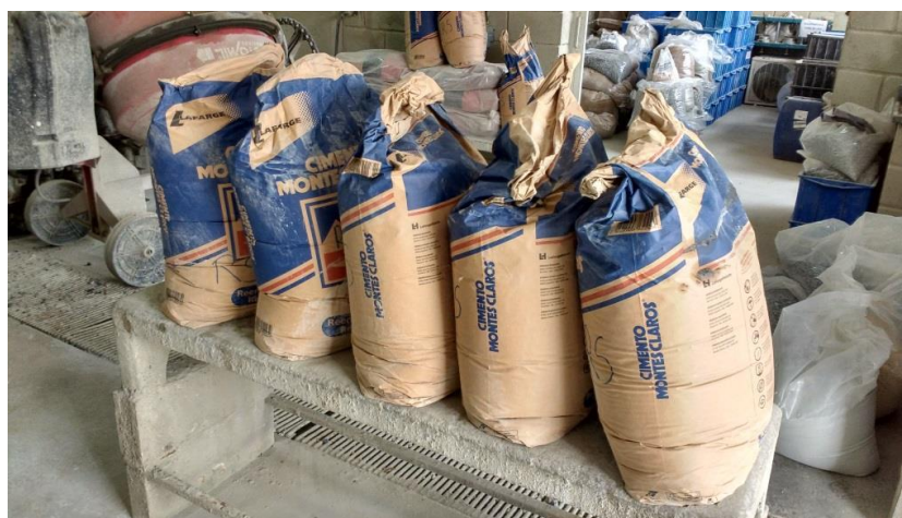
Figura 4.2 - Cimento CP V ARI RS utilizado na pesquisa.
