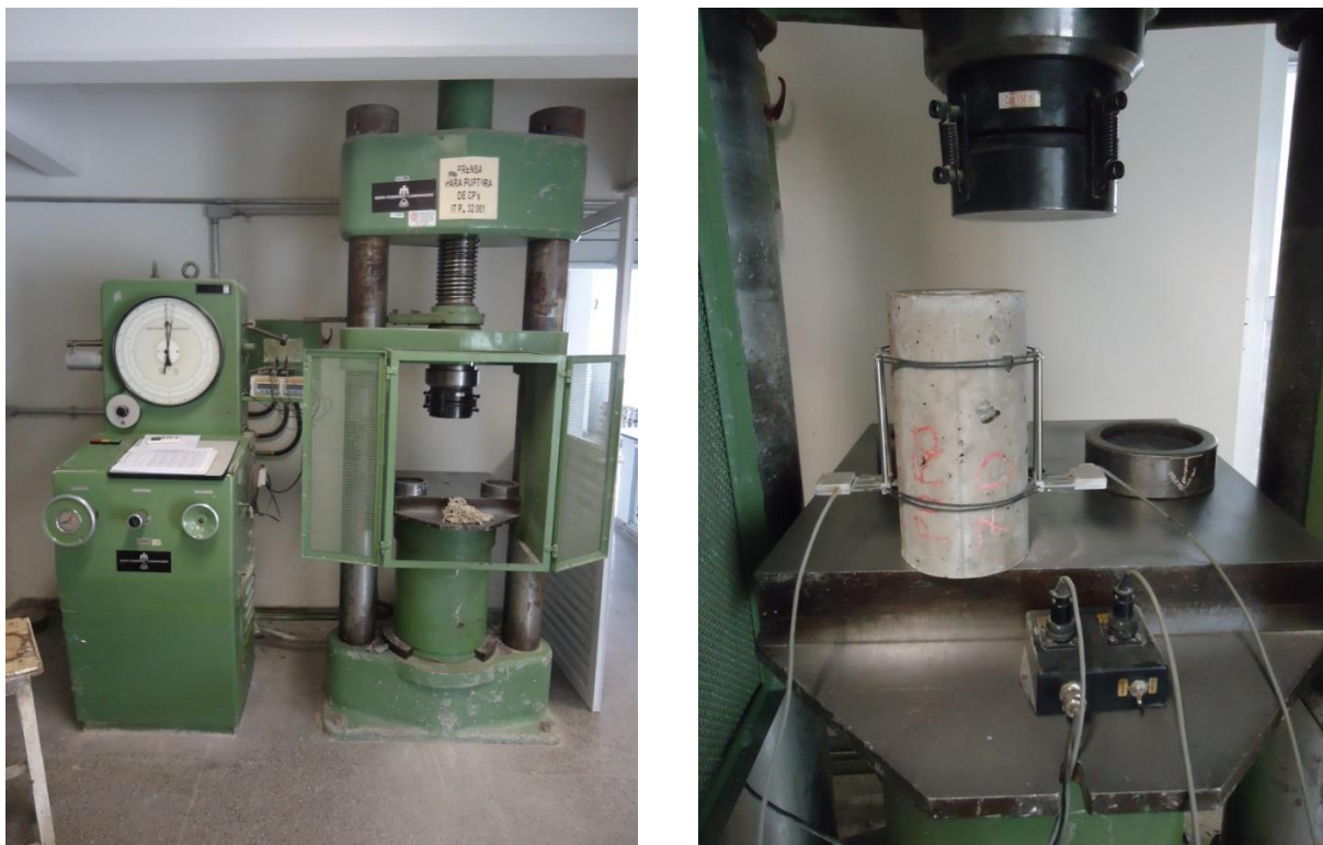
Figura 4.19 - Prensa utilizada e corpo de prova equipado com LVDT's, 2017.
