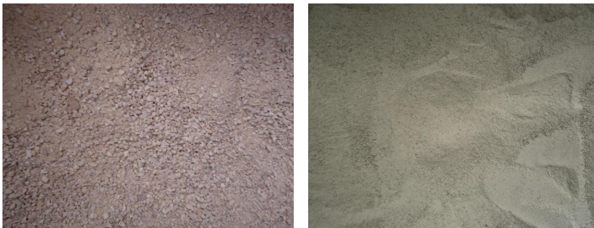
Figura 5.1 – Fotografia das areias natural de cava e artificial de gnaiss, 2017.
