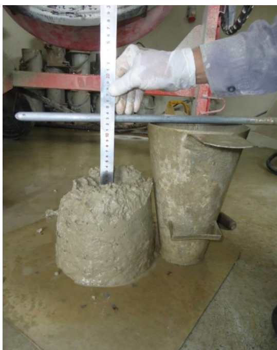
Figura 4.9 - Verificação do Slump do concreto, 2017.
