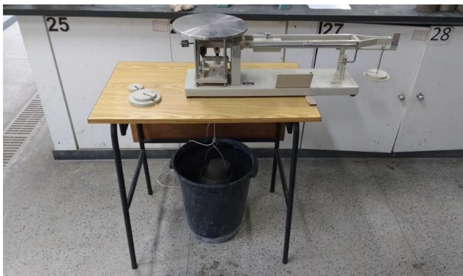
Figura 4.25 - Determinação da massa do corpo de prova imerso em água, utilizando balança hidrostática, 2017.
