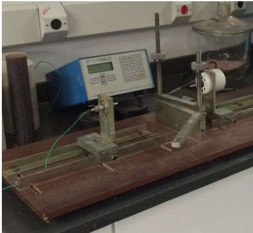
FIGURA 6: Equipamento de medição do módulo de elasticidade por frequência ressonante
