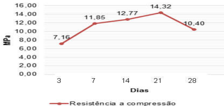
FIGURA 40: Gráfico de resistência mecânica à compressão CPII
