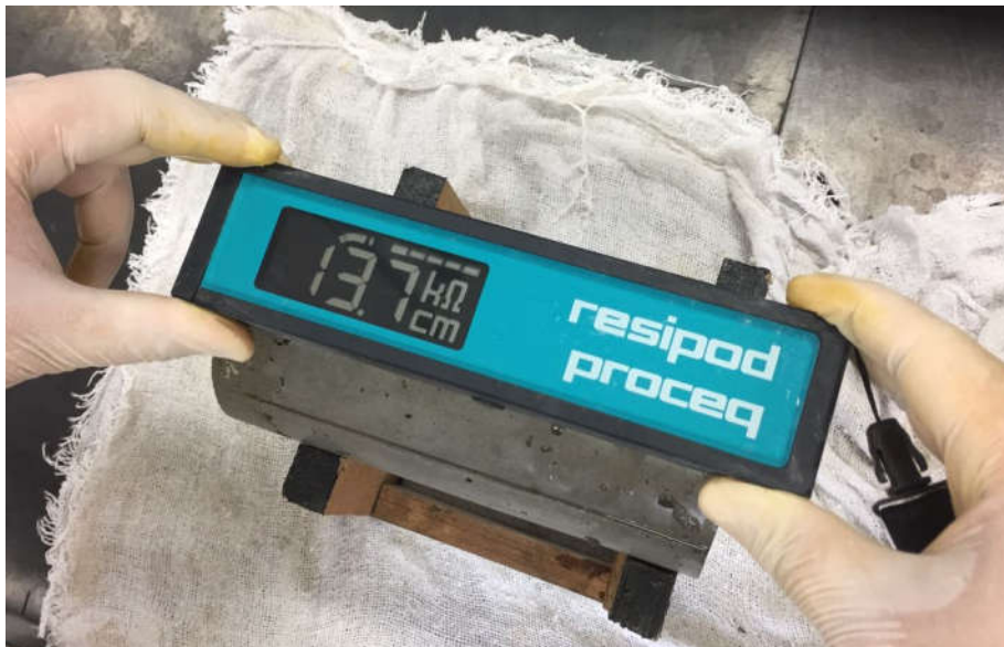
FIGURA 19: Medidor de resistividade elétrica
