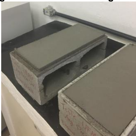
Figura 25 - Blocos com argamassa
