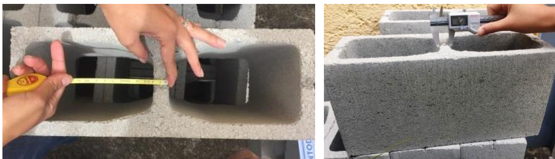
Figura 12 - Espessura dos septos dos blocos a serem ensaiados (18 mm)
