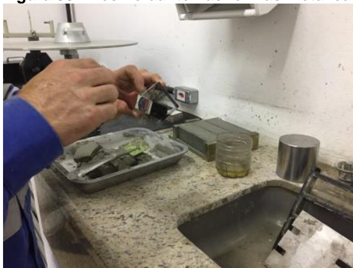
Figura 33 - Desmoldante nas fôrmas metálicas
