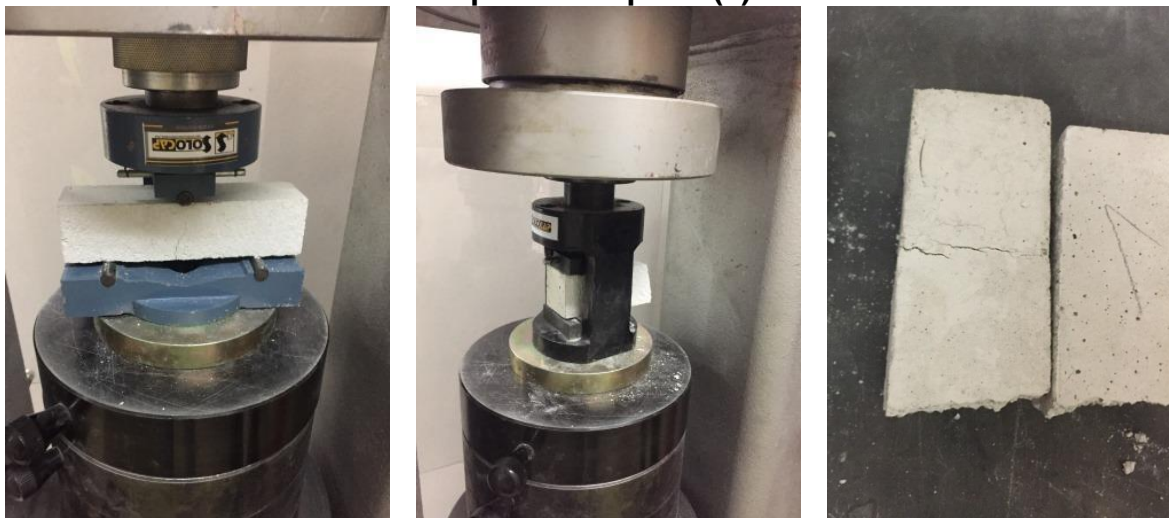
Figura 21 - Ruptura à tração na flexão(a), ruptura à compressão(b), corpos de prova rompidos(c)
