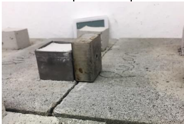
Figura 36 - Fôrmas coladas na pastilha e encapsulando o corpo de prova
