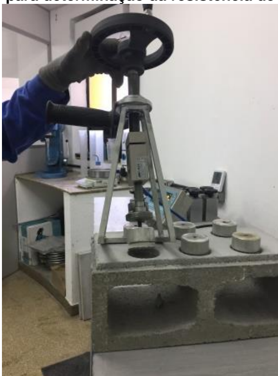
Figura 27 - Ensaio para determinação da resistência de aderência à tração
