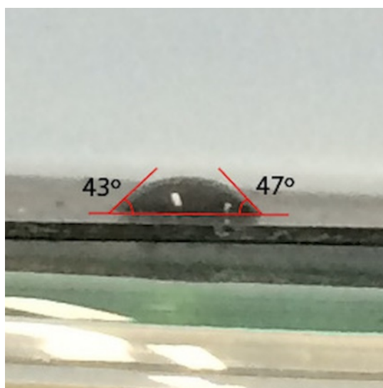
Figura 19: Fotografia de gota d'água sobre a superfície de uma amostra.
