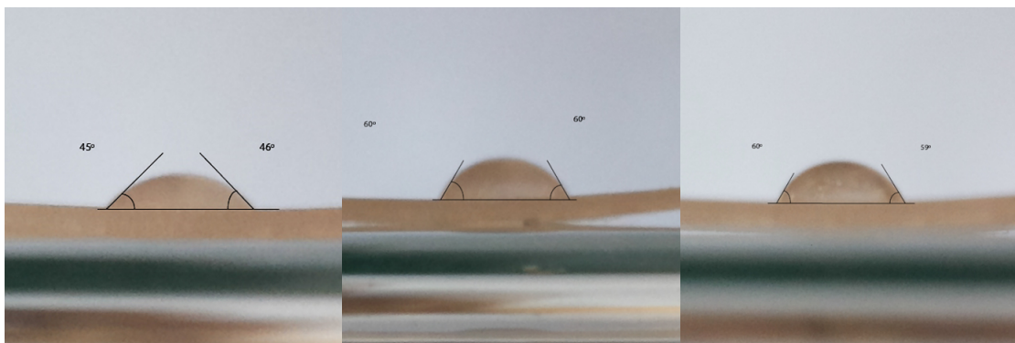
Figura II.2: Medidas do WCA para a amostra XLPE0 envelhecida por 1000 horas.
