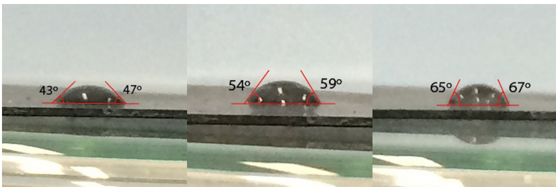
Figura II.27: Medidas do WCA para a amostra XLPEB2T envelhecida por 2000 horas.
