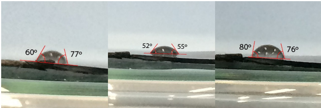
Figura II.20: Medidas do WCA para a amostra XLPEA2T envelhecida por 1000 horas.
