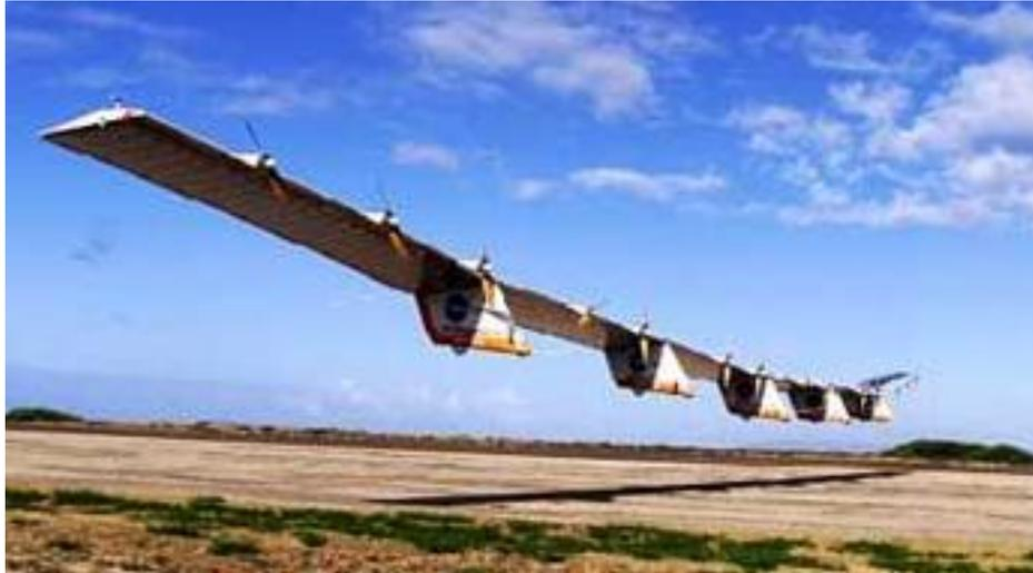
FIGURA 4.3 - Compartimentos que levam carga paga no Helios.
