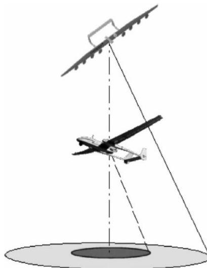
FIGURA 2.4 - Áreas de monitoramento entre aeronaves a diferentes altitudes.
