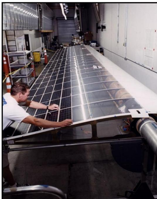
FIGURA 3.15 - Segmento da asa da aeronave Helios.
