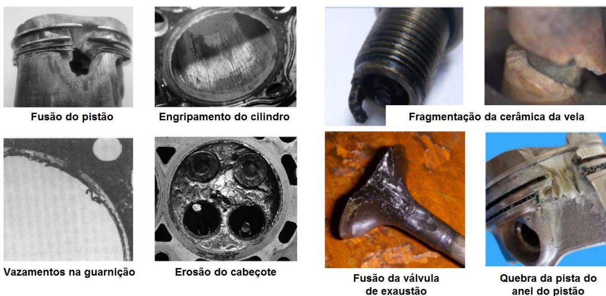
Figura 2.11 – Efeitos da operação contínua em regime de detonação em motores de combustão interna.
