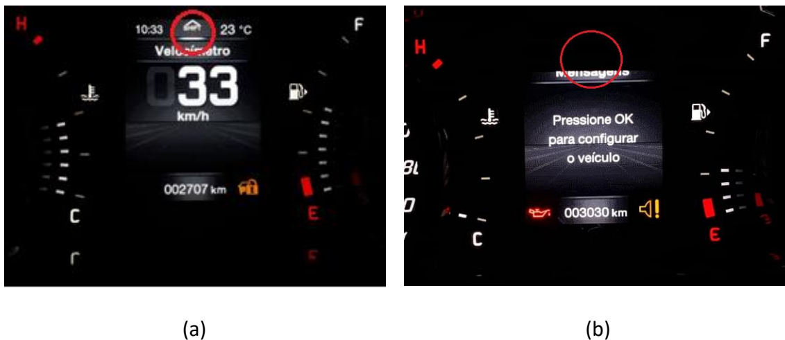
FIGURA 3.9: Procedimentos para os Testes: (a) Painel do Carro com GSI disponível; (b) Painel do Carro com GSI tapado.
