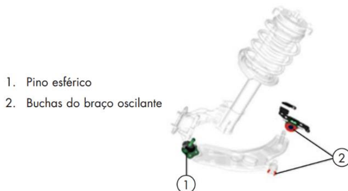
Figura 28 – Localização de buchas e pinos esféricos numa suspensão
