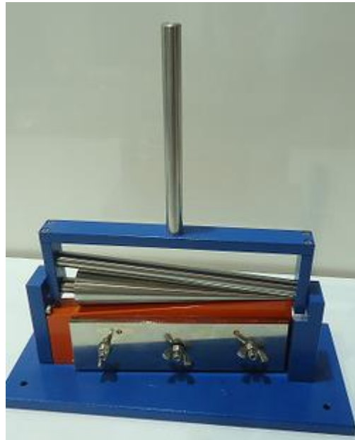
Figura 8: Mandril cônico utilizado no ensaio de flexibilidade.
