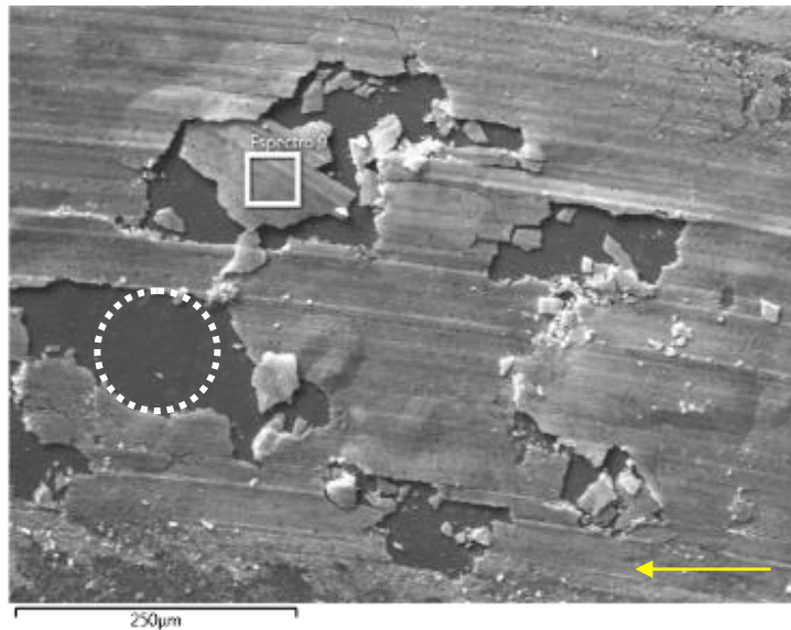
Figura 63: Material oxidado formado sobre a pista de deslizamento após teste de pino sobre disco do aço ABNT 8620 revestido com DLC.
