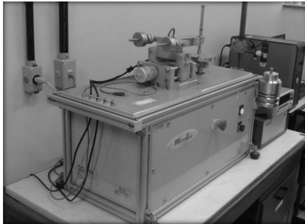
Figura 52: Tribômetro Microtest modelo MT/60/NE
