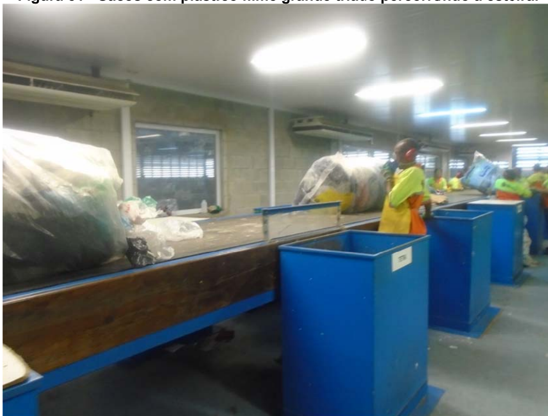
Figura 31 - Sacos com plástico filme grande triado percorrendo a esteira.
