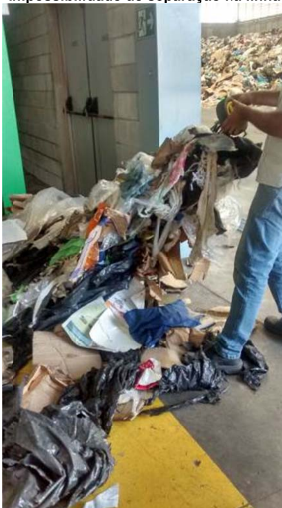
Figura 21 - Aglomerado de material formado por material "enroscante": impossibilidade de separação na linha
