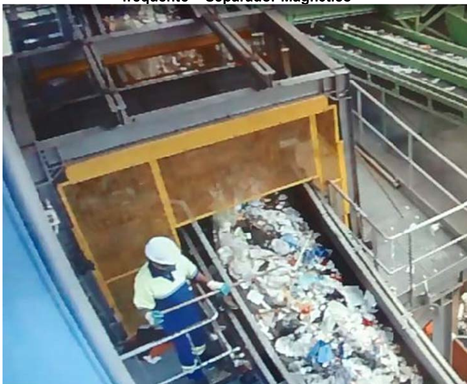
Figura 30 - Trabalhador monitorando e regulando ponto de obstrução de fluxo frequente – Separador Magnético
