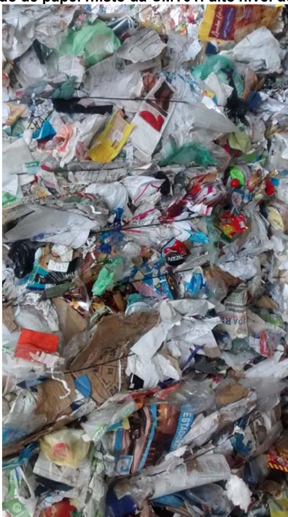
Figura 23 - Fardo de papel misto da CMT01: alto nível de contaminação
