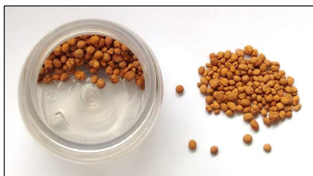
Figura 4.5. Aspecto visual dos fotocatalisadores pelletizados (P1) após calcinação.
