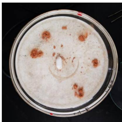
Figura 8.2. Imagem de pellets que não resistiram ao teste.
