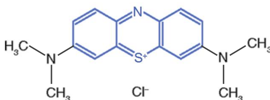
Figura 3.4. Representação da molécula de azul de metileno e seu cromóforo, a estrutura fenotiazina (destaque em azul).
