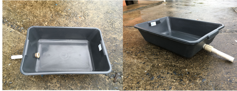
Figura 4.12. Calhas plásticas colocadas dentro no meio de suporte dos leitos I e II do WCEV-SF 1º estágio
