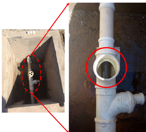
Figura 4.19. Sonda multiparâmetro YSI modelo 600XL V2-1 colocada na durante o monitoramento dos valores de condutividade elétrica nos testes com traçador salino
