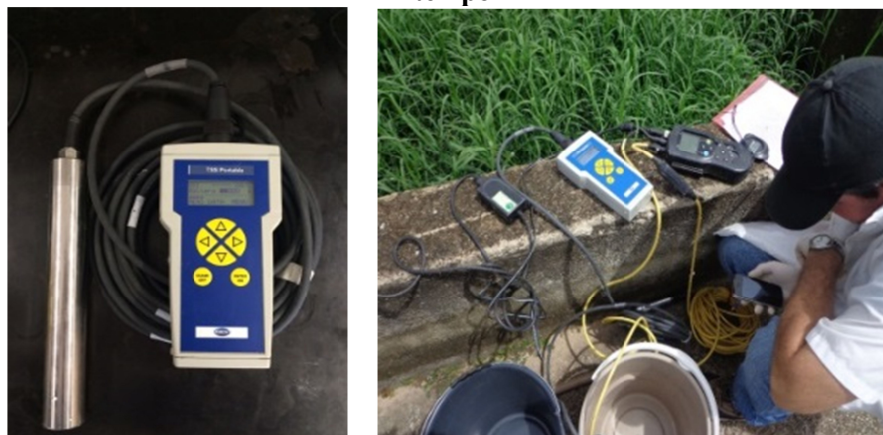
Figura 4.17. Sonda SST e medições das concentrações de SST na saída do efluente ao longo do tempo
