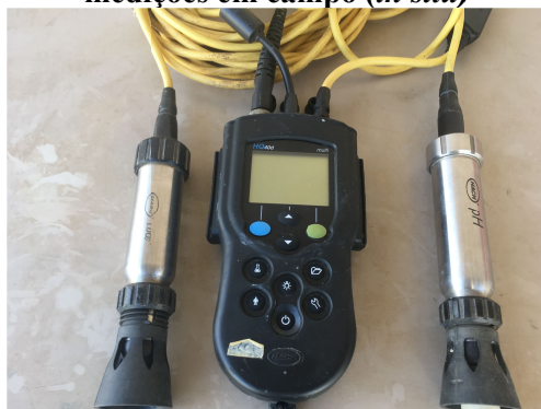
Figura 4.10. Sonda Multiparâmetros (HACH DO023.53.90050/HQ40) utilizada para as medições em campo ( in situ )
