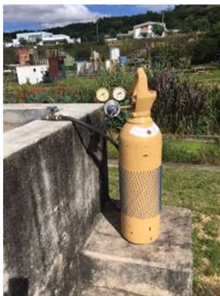
Figura 4.21. Cilindro de gás propano utilizado para os ensaios de transferência de oxigênio
