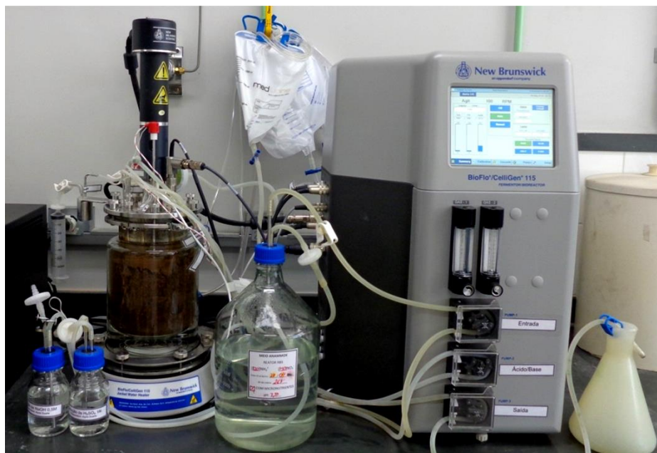
Figura 4.2: Reator em bateladas sequenciais utilizado no projeto, com biomassa anammox
