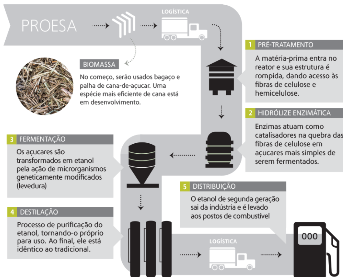
Figura 10: Esquema representativo das etapas de produção do etanol de celulose de palha e bagaço de cana-de-açúcar, utilizando a tecnologia de pré-tratamento Proesa ® , licenciada pela Beta Renewables para a Bioflex 1 (GranBio,2017).
