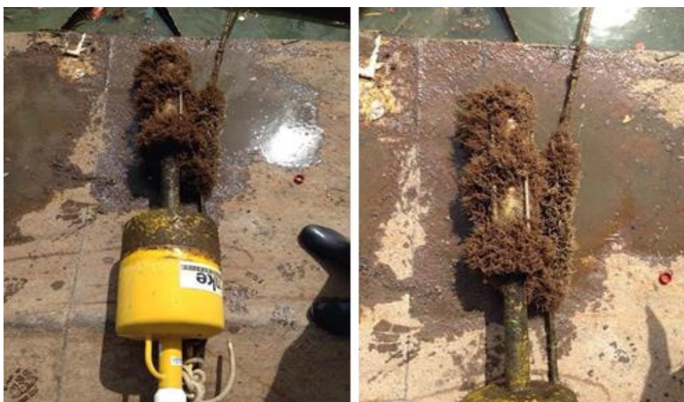
Figura 5.5 - Sensores da boia afetados pelo acúmulo de biofilme
